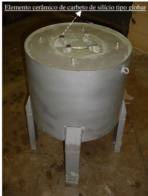
Figura 3.7. Dispositivo de solidificação unidirecional.
