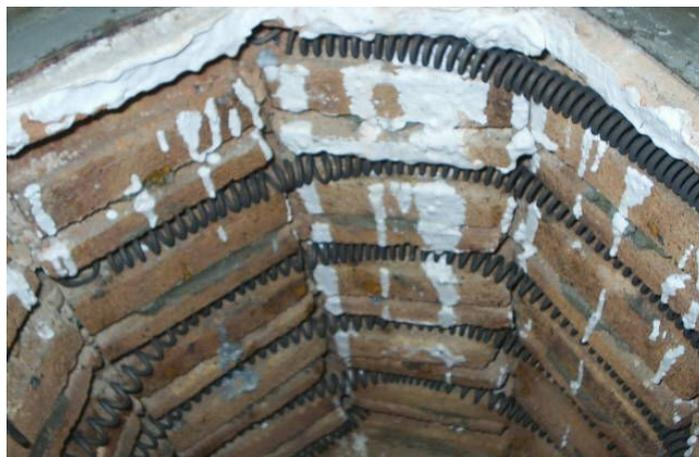
Figura 3.3. Detalhe do forno , apresentando a resistência elétrica.
