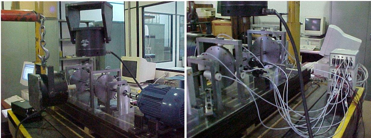
Figura 6.12 – (a) Detalhe da instrumentação utilizada: (a) Vista do motor elétrico e *shaker*; (b) Sensores de proximidade, cabos e os condicionadores dos sensores.
