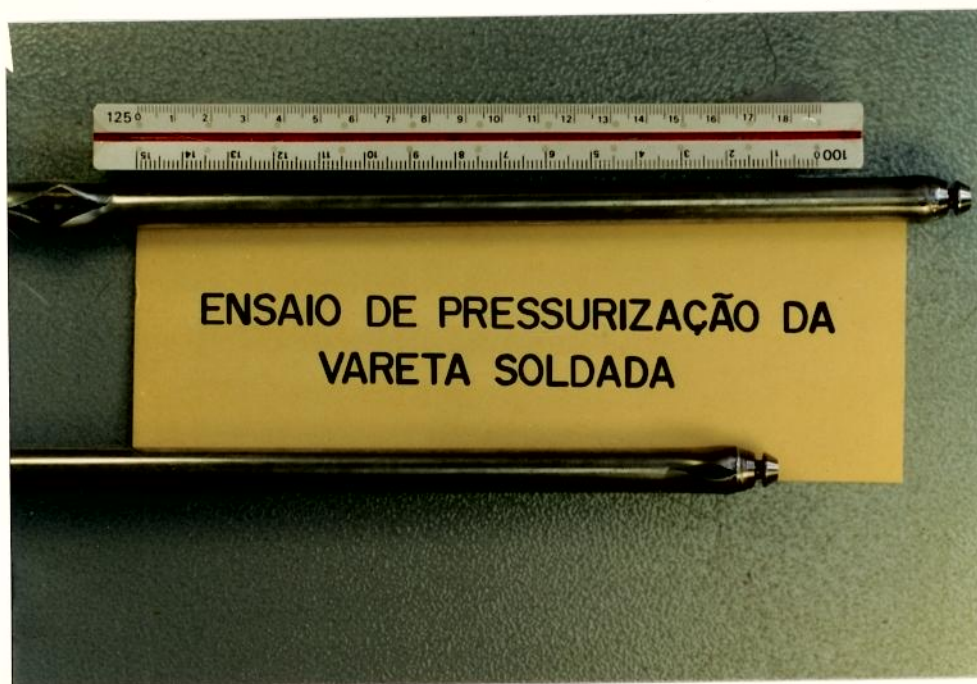
FIGURA 21. Corpos de prova submetidos a ensaio de arrebentamento com fratura fora e na região da solda.
