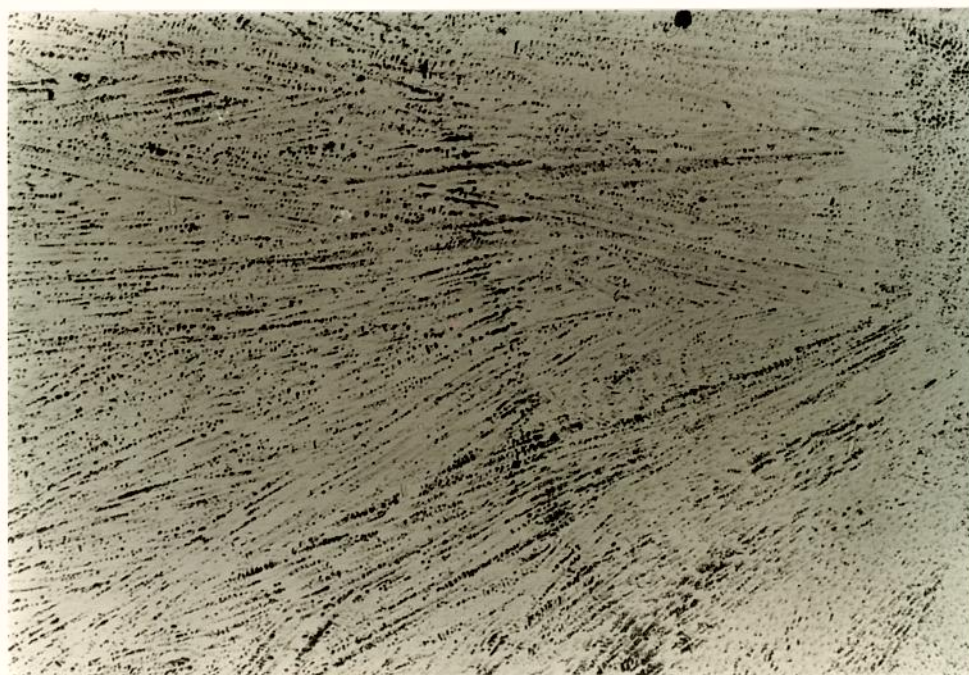
FIGURA 30. Microestrutura obtida através de ataque metalográfico magnético. (250 x)
