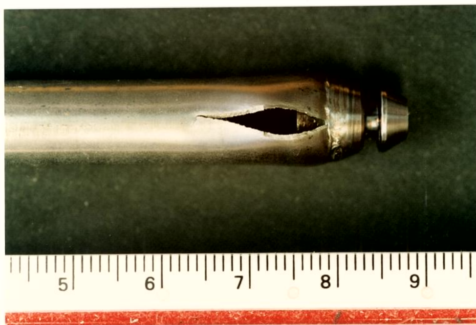
FIGURA 22. Corpo de prova submetido a ensaio de arrebentamento com fratura no cordão de solda, induzida por defeito de soldagem.
