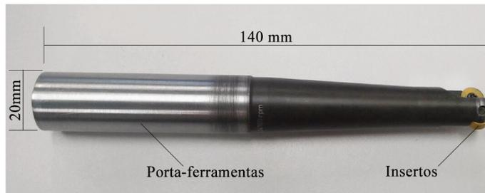
Figura 3.2: Porta-ferramentas utilizado nos testes de fresamento.
