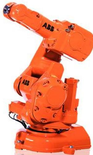
Figura 62. Robô manipulador ABB 140
