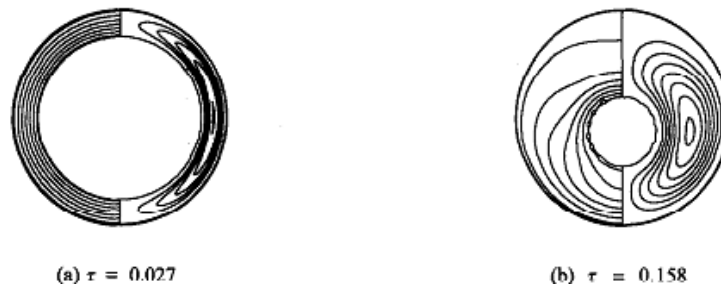
Figura 2.30. Isotermas (à esquerda) e linhas de corrente (à direita). Resultado numérico obtido por Chung et al. (1997) com Ste = 0,045 , Ra = 1,0 \times 10^4 e Sc = 0,004 .
