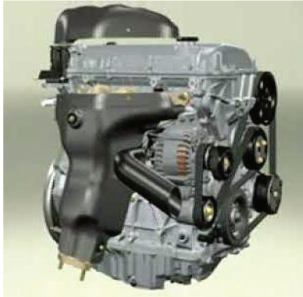
Figura 3.1: Motor de combustão interna alternativo de ignição por centelha (Ford, 2000).
