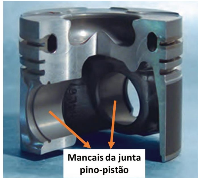
Figura 4.2: Corte de um pistão automotivo destacando os furos de inserção do pino. Adaptado de Mahle, 2015/2016.
