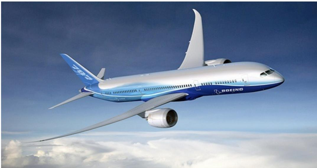
Figura 2.1: Boeing 787 "Dreamliner", cujos componentes fabricados com materiais compósitos eram estimados na fase de projeto como aproximadamente 50% do peso total da aeronave. [foto: Boeing.com]
