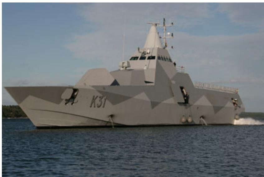
Figura 2.3: Navio da marinha real sueca cujo peso é de aproximadamente 600 toneladas e possui grande parte da estrutura fabricado em materiais compósitos.
