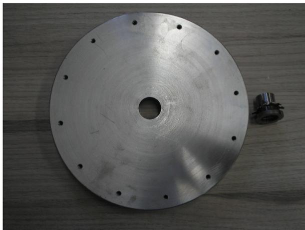
**Figura 6.2: Representação do disco e bucha de fixação**
