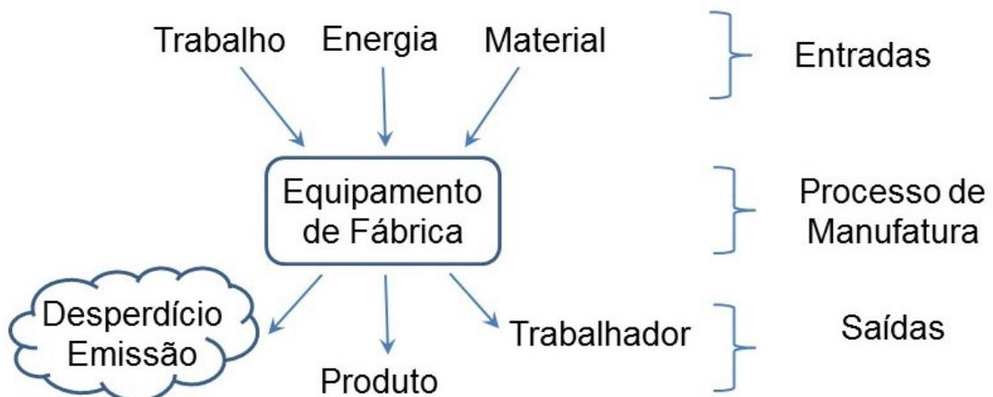
Figura 1 - Modelo da manufatura de Entradas-Processo-Saídas (adaptado de STARR, 1972; YAUN, ZHAI e DORNFELD, 2012 e ROKHMAWATIA, SATHYE e SATHYE, 2015).
