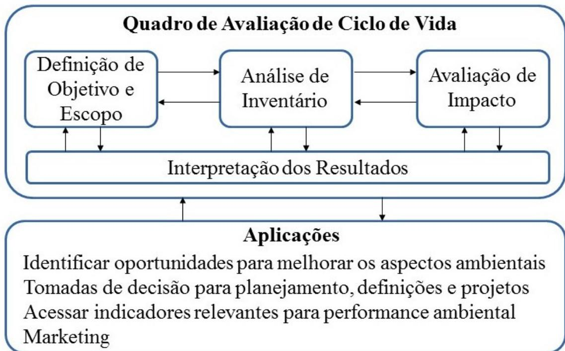
Figura 14 – Quadro para condução de uma avaliação de ciclo de vida e suas principais aplicações (adaptado da ABNT NBR ISO 14040:2009).
