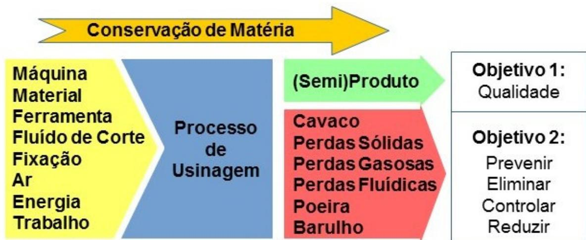
**Figura 19 – Modelo de Entrada-Processo-Saída para processos de usinagem (adaptado de ZHI-GANG, HUA e MING, 2008 e DEIF, 2011).**
