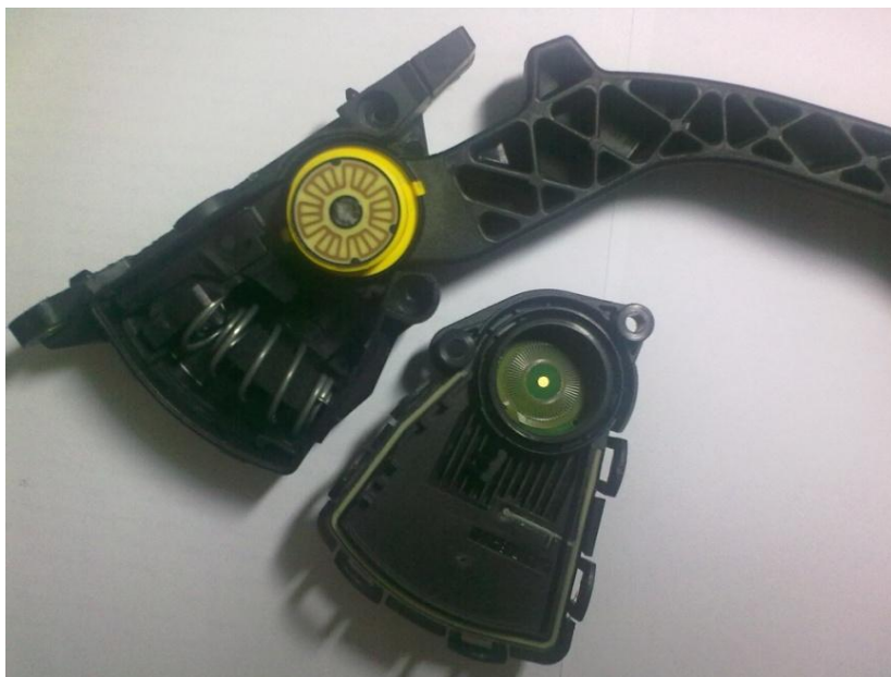
Figura 9 - Exemplo de pedal de acelerador utilizando sensor do tipo LVDT
