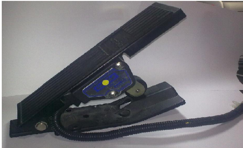
Figura 11 - Exemplo de Pedal de Acelerador Utilizando Sensor Hall
