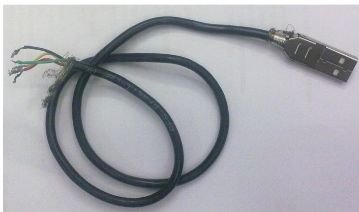
Figura 54 - Cabo utilizado para interligar o circuito ao sensor capacitivo
