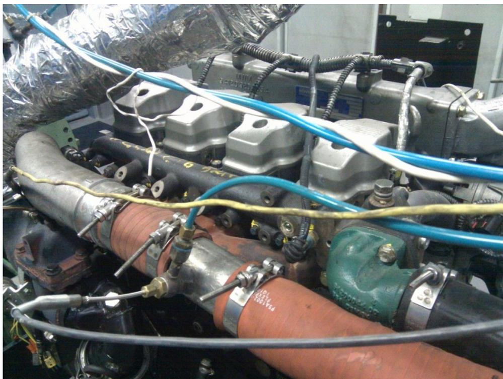
Figura 29: Motor WMM Maxxforce 4.8H instalado em banco de testes
