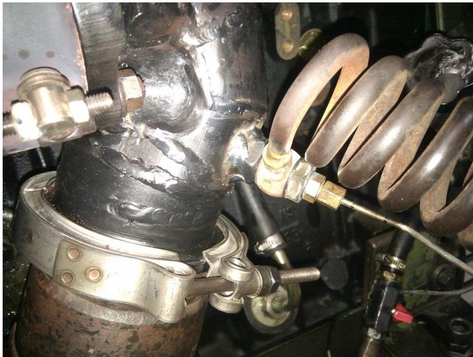
Figura 39: Instrumentação de Pressão e temperatura no escapamento
