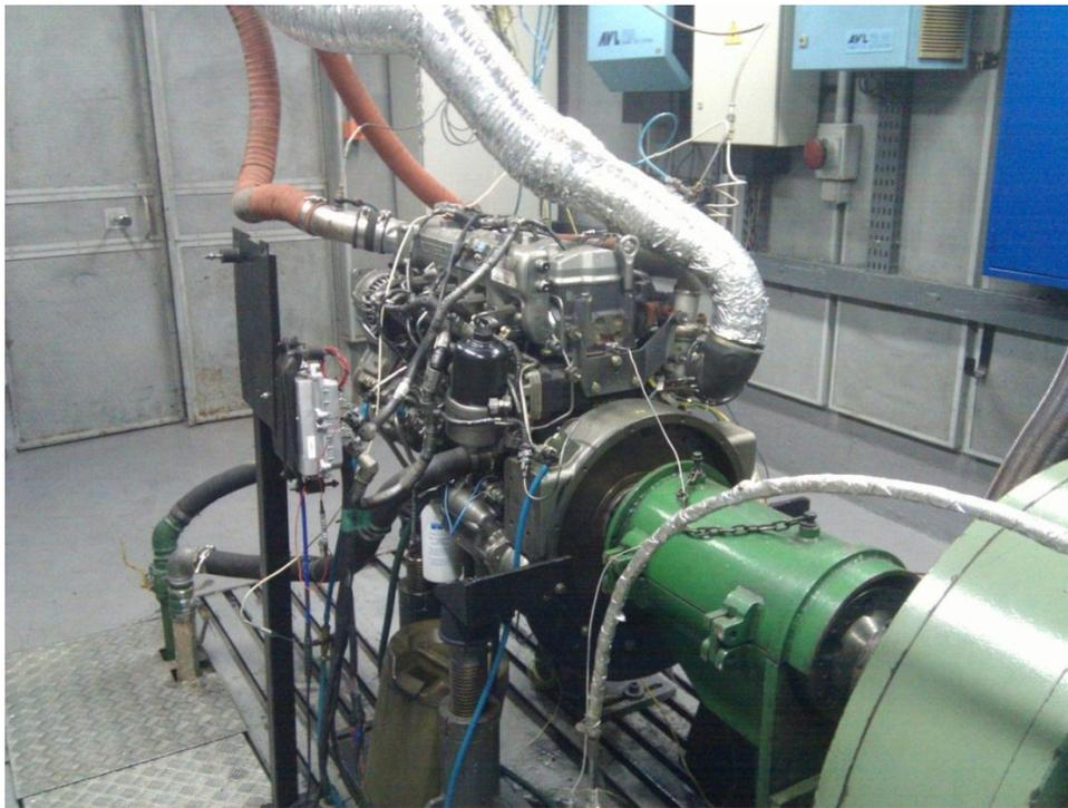
Figura 28: Motor MWM MaxxForce 4.8H Euro V instalado em banco de testes
