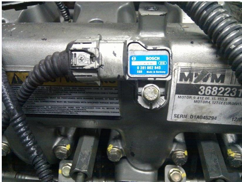
Figura 26: Sensor de pressão e temperatura do ar no coletor de admissão
