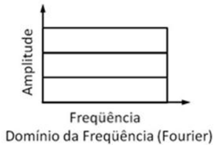
Figura 2.1 - Resolução tempo-freqüência para a Transformada de Fourier.
