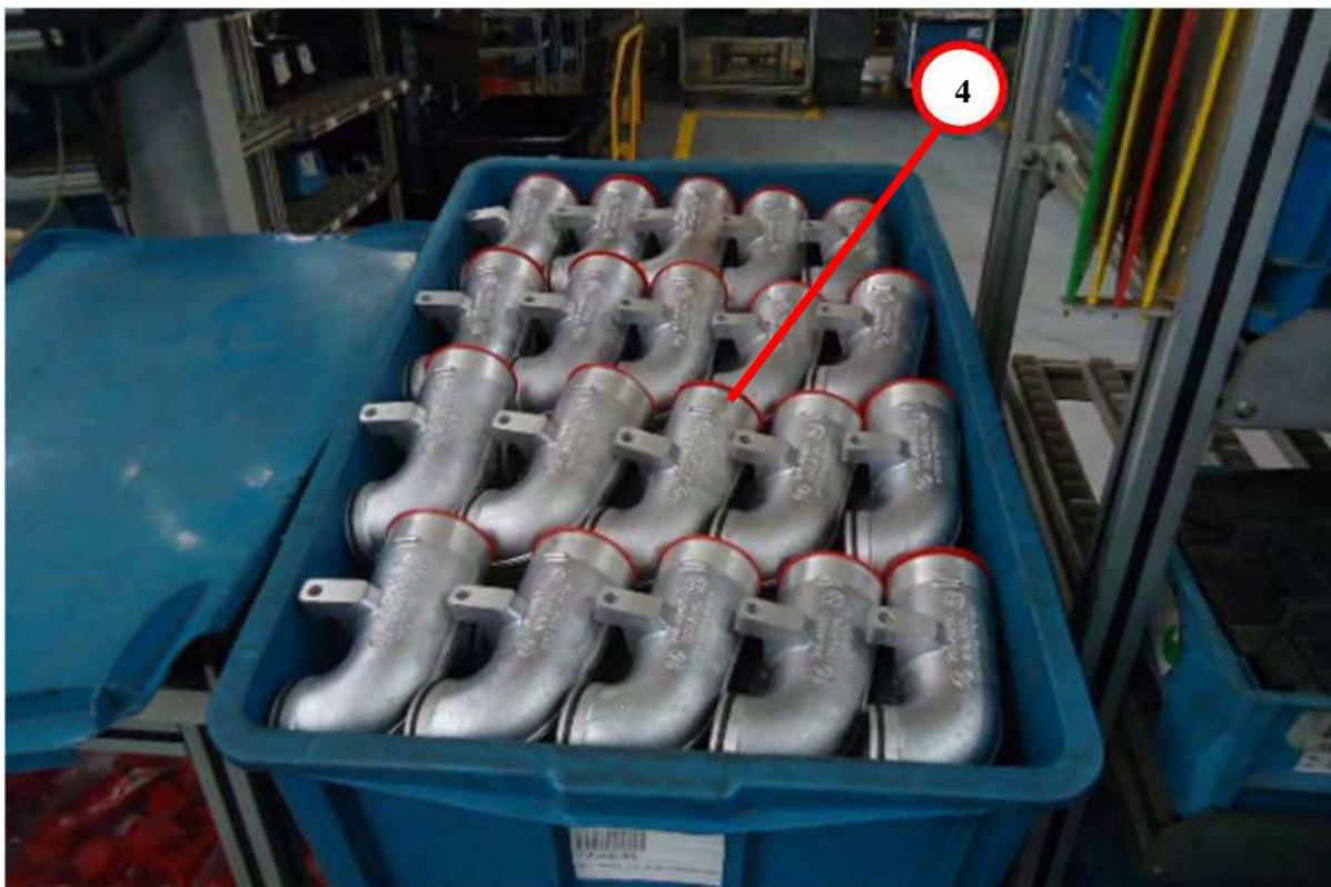
Figura 35: Estoque em processo de dutos de entrada de ar na operação 185 SM
