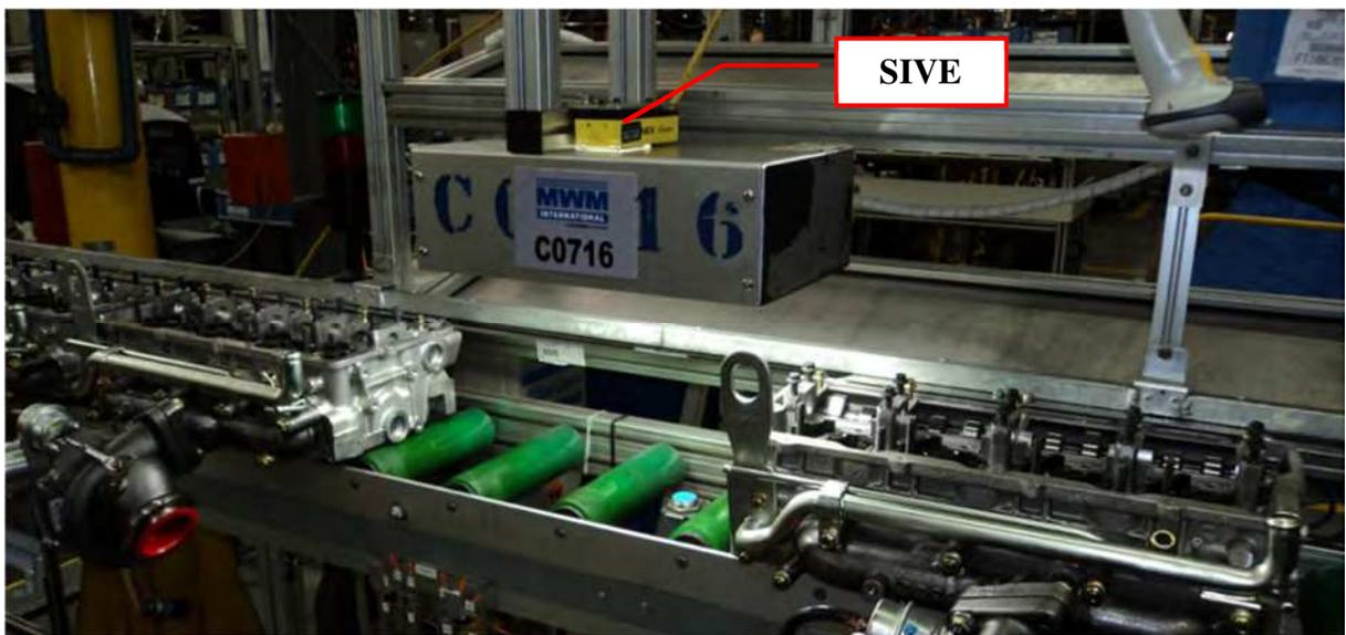
Figura 40: Sistema de Inspeção Visual Eletrônico da presença e posição das pontes de válvula
