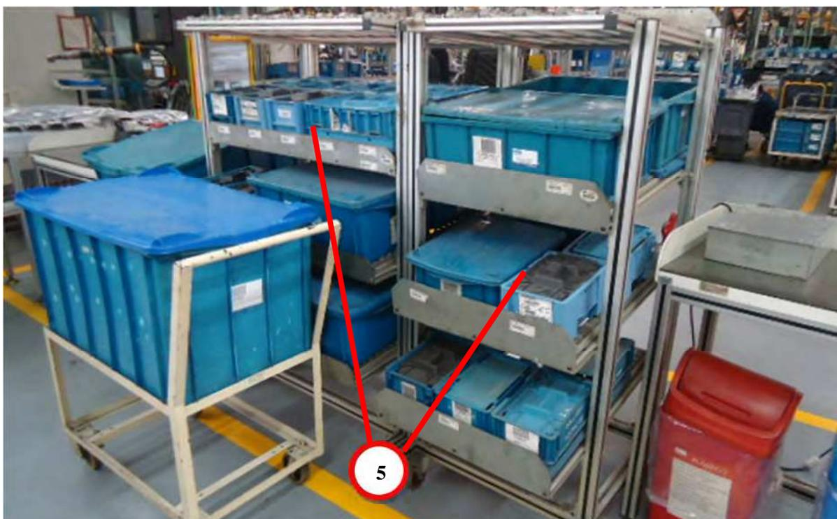
Figura 36: Prateleira de armazenamento de componentes da operação 185 SM
