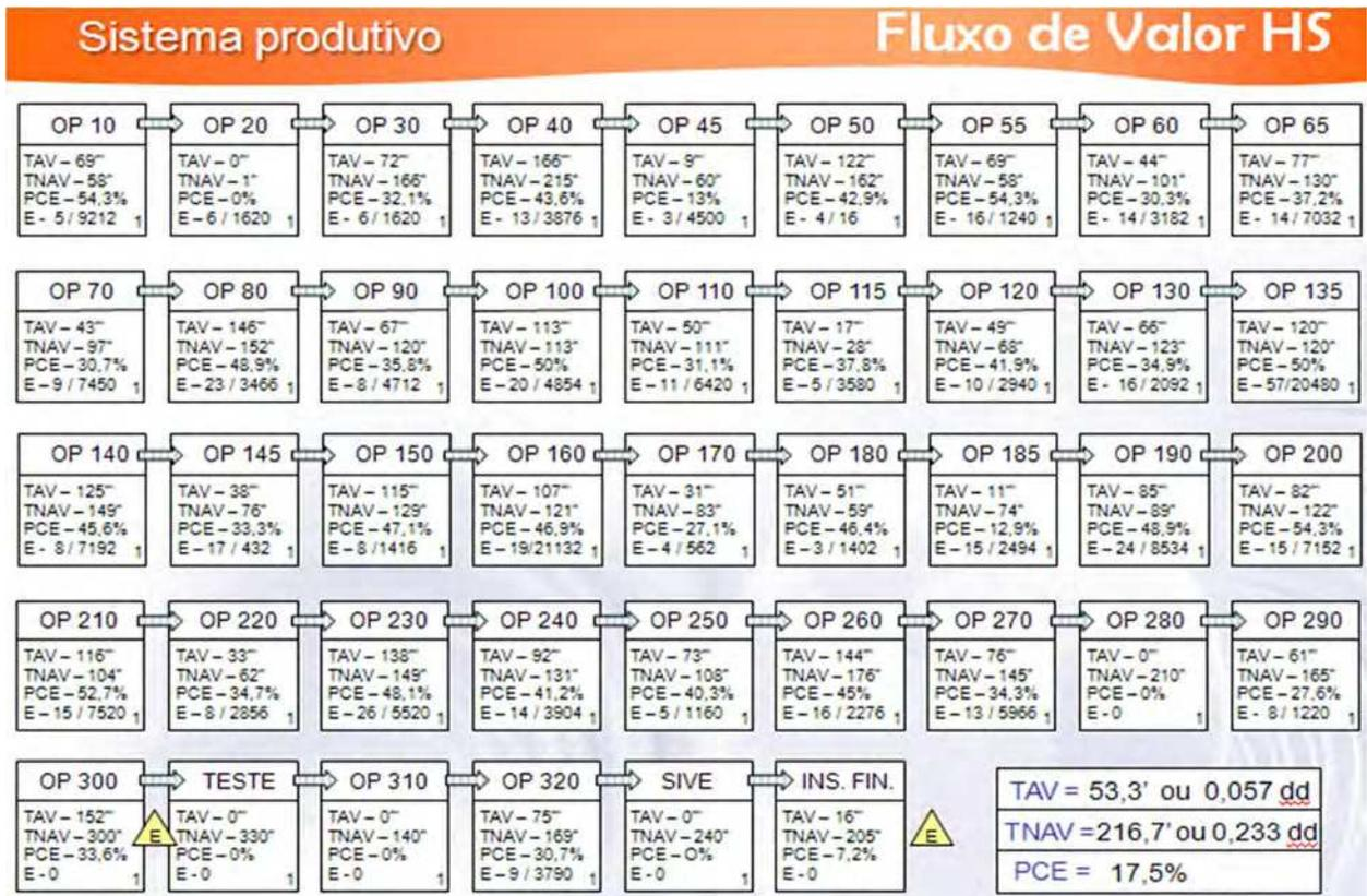
Figura 29: Mapeamento do processo produtivo da linha HS por operação (posto a posto)
