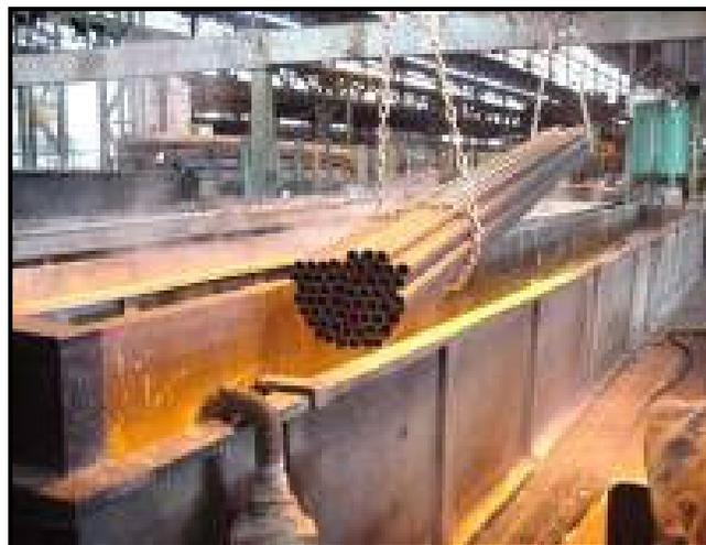
FIGURA 2.8 – Processo de decapagem química do tubo. Foto gentilmente cedida pela V&M Brasil.
