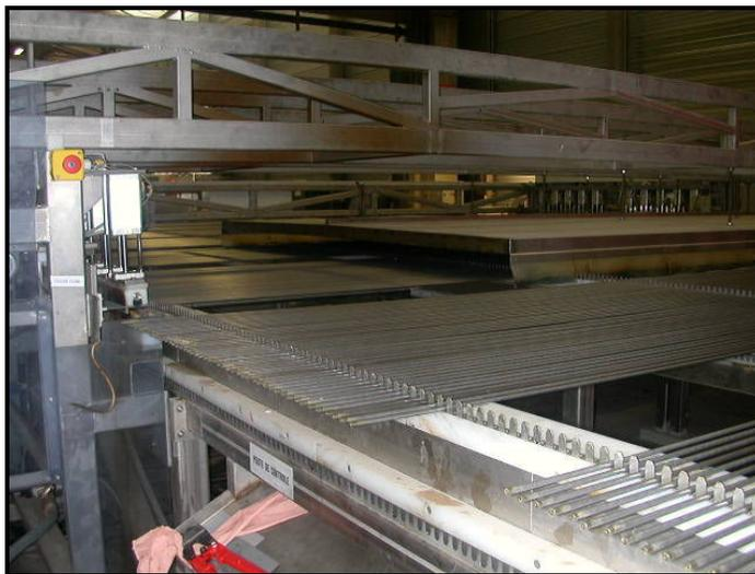
FIGURA 2.11 – Equipamento de polimento eletrolítico da V&M França. Foto gentilmente cedida pela V&M Brasil.
