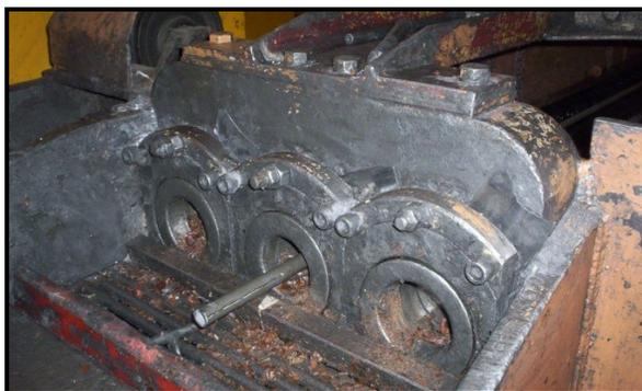
FIGURA 2.9 – Equipamento de trefilação com três matrizes. Foto gentilmente cedida pela V&M Brasil.
