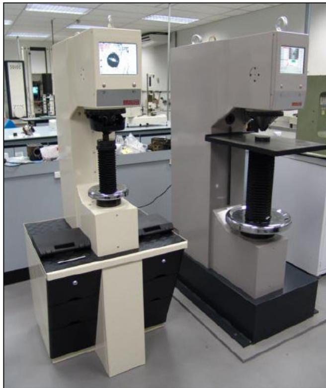
FIGURA 4.7 – Equipamento de medição de dureza EMCO da MWM International.
