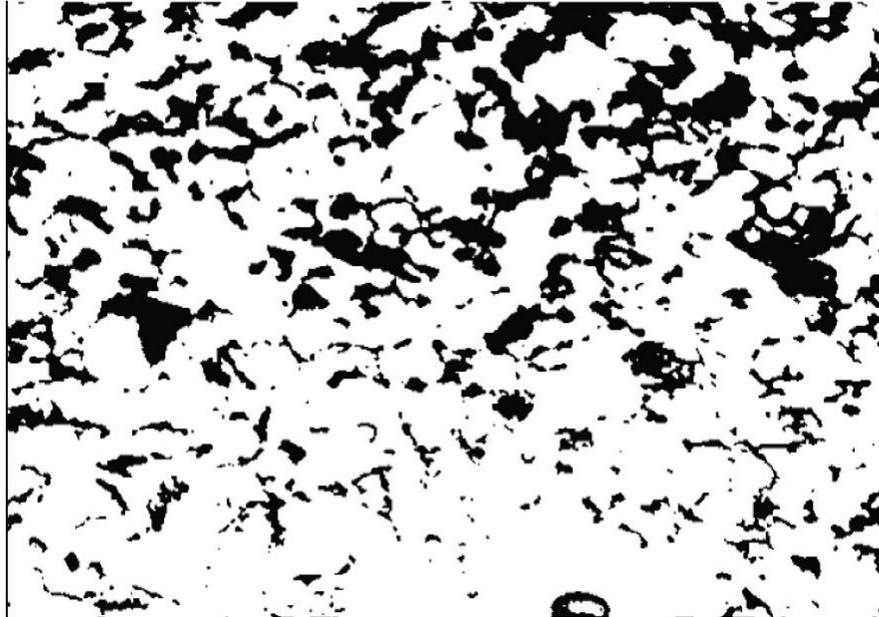
FIGURA 5.13 – Imagem das fases Ferrita (87,45%) e Perlita (12,55%) do aço St52 VM-NP.
