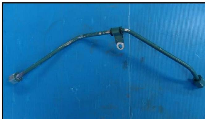
FIGURA 3.1 – Tubo que falhou no teste de durabilidade. Foto gentilmente cedida pela MWM International.
