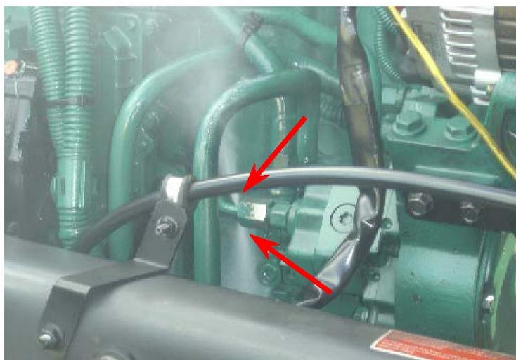
FIGURA 1.1 – Vazamento de óleo diesel em veículo após 28.000 km. Foto gentilmente cedida pela MWM International Motores.
