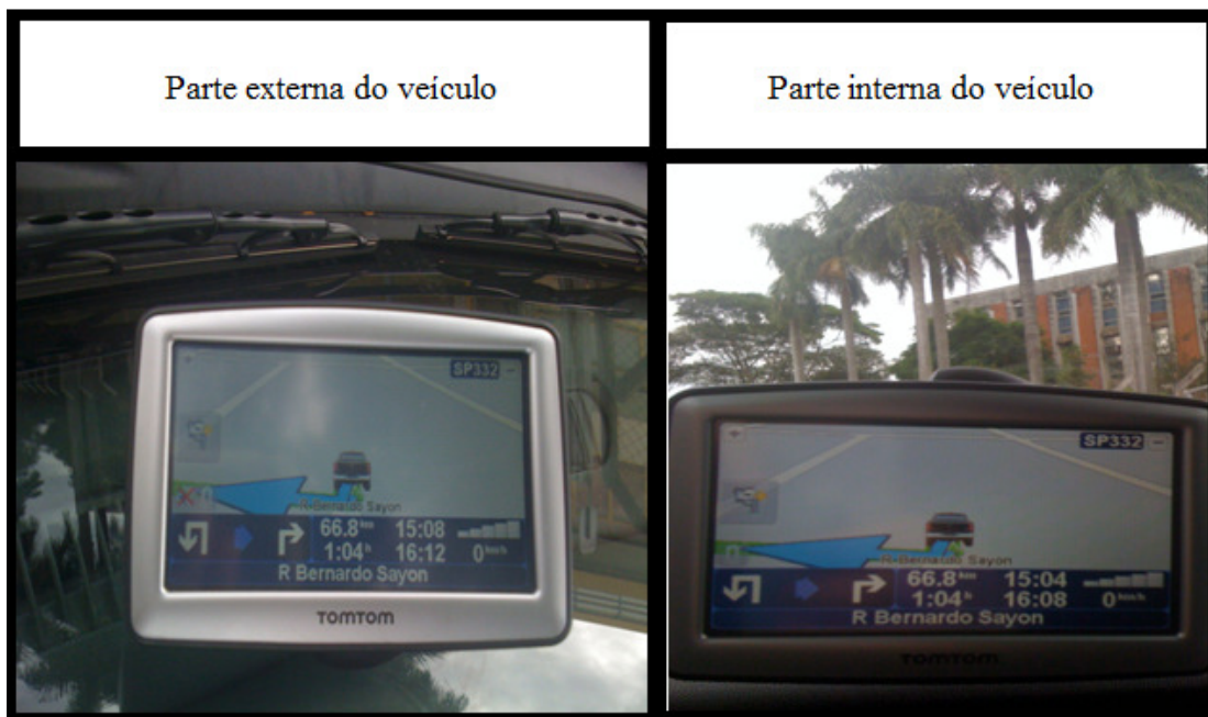
Figura 14: GPS TOM-TOM modelo XL utilizado para medir a variação na intensidade do sinal quando localizado dentro do veículo (influência do vidro) e quando colocado na mesma posição de fixação fora do veículo (sem a influência do vidro).
