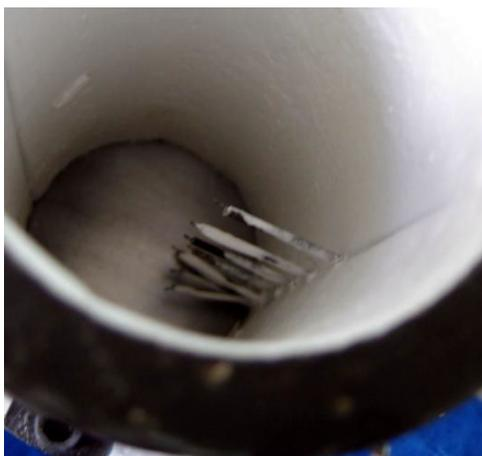
Figura 3.11. Vista de topo da lingoteira montada mostrando o posicionamento dos termopares.
