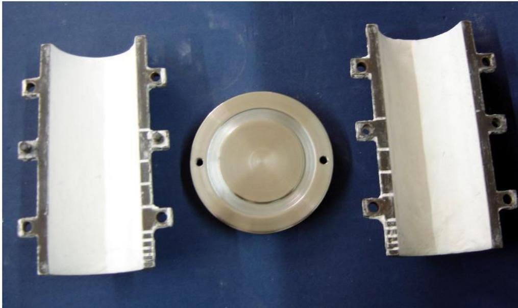
Figura 3.9. Lingoteira e a chapa molde, ambas em aço inoxidável, utilizadas na solidificação ascendente.
