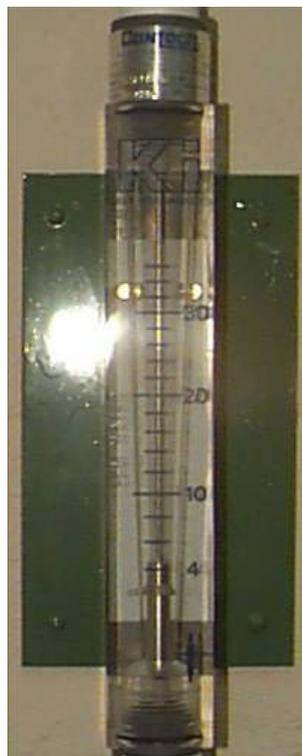
Figura 3.3. Rotâmetro controlador da vazão de água utilizada nos experimentos.
