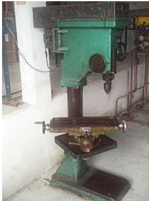
Figura 3.16. Imagem da furadeira de mesa utilizada para retirada dos cavacos.
