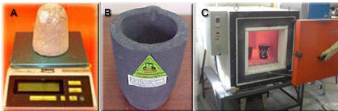
Figura 3.2. (A) Balança digital, (B) cadinho de carboneto de silício e (C) forno elétrico tipo mufla.
