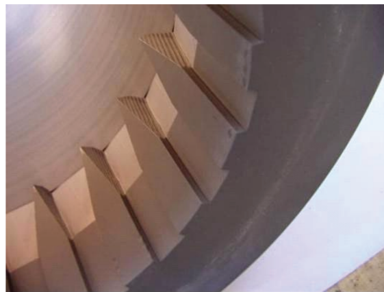
Figura. 4.8: Detalhe interno dos furos do canal de ar externo (axial) do queimador Combustech, denominado GG-NA. Patentes requeridas: Fernandes (março 2002), Fernandes (Junho 2002), Fernandes (Novembro 2003) e Fernandes (Março 2005).
