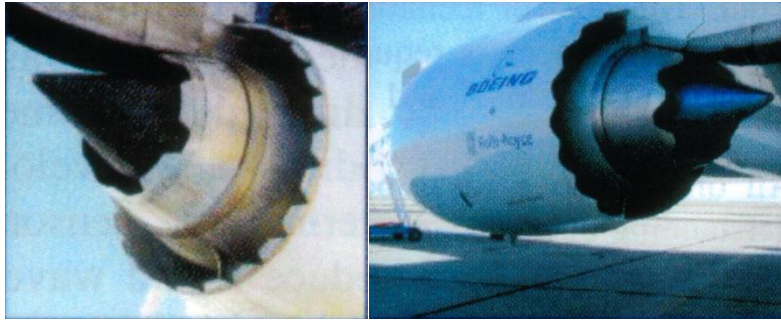
Fig. 3.6: turbinas QTD Rolls Royce em aviões Civis Boeing 777, os cortes nas saída da turbina visam a redução de ruído de até 17 dB. Ruffles (2003)
