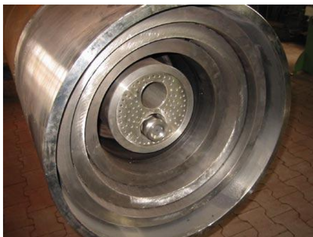
Fig. 2.15: Queimador Rotaflam para carvão, combustíveis líquidos e gasosos, onde que os canais podem ser recuados, ou seja, não ficam faceados. Pillard (2005).
