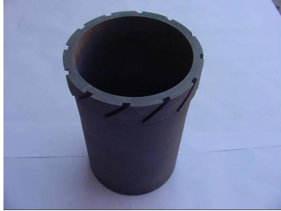
Fig. 4.9: Detalhe do swirler de aletas empregado no queimador Combustech, denominado GG-NA Patentes requeridas: Fernandes (março 2002), Fernandes (Junho 2002), Fernandes (Novembro 2003) e Fernandes (Março 2005).
