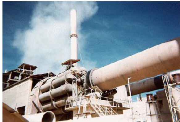
Fig. 3.3: forno com resfriadores satélites presos ao casco do forno
