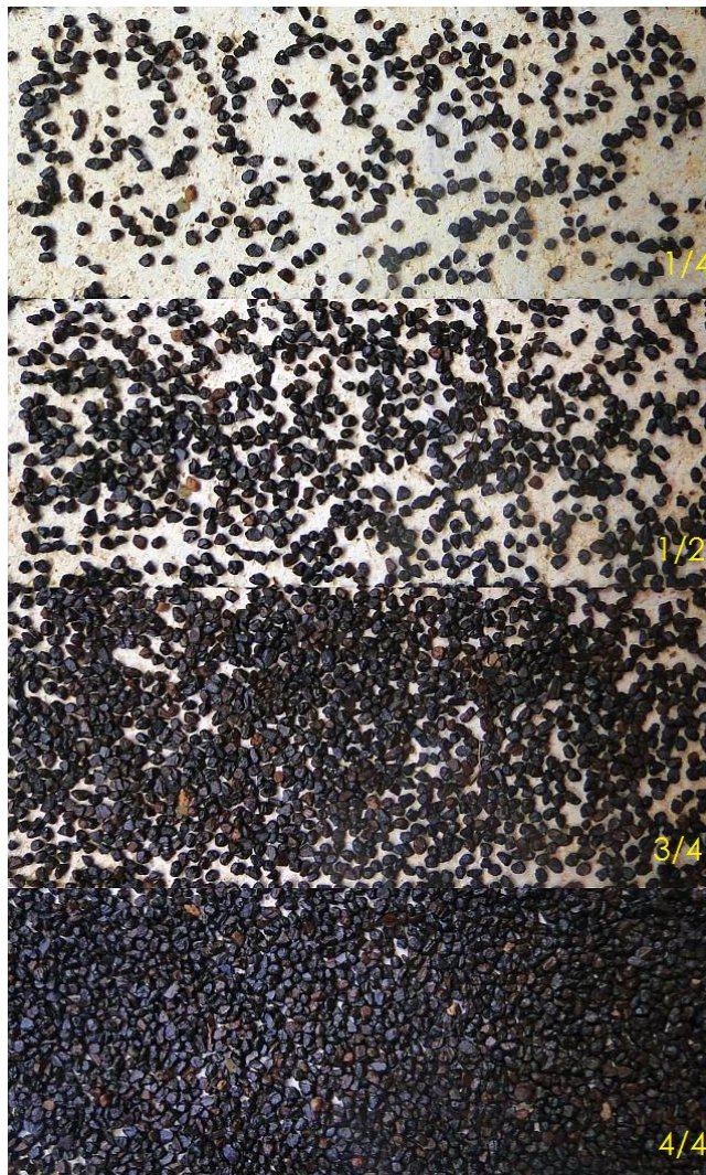
Figura 55 - Monocamadas parciais e monocamada total na superfície de um corpo de prova
