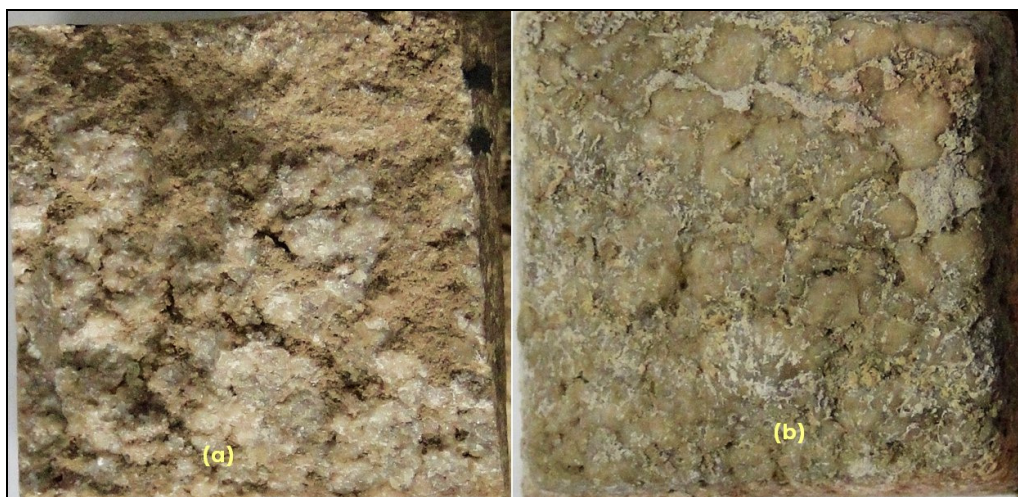
Figura 51 - aspecto da superfície por tração do Ctr 3 antes (a) e depois (b) da reação com ácido
