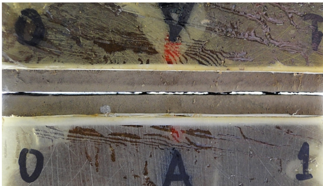
Figura 1 - Pontos de contato das irregularidades que mantém uma fratura ácida aberta
