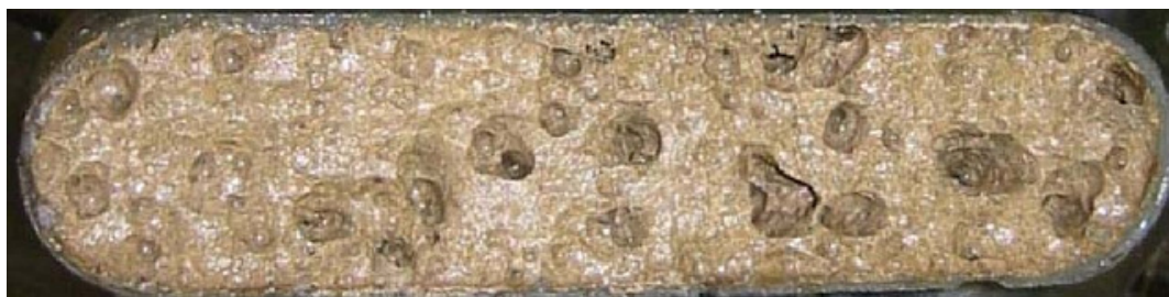
Figura 4 - Efeito do CO 2 no padrão de dissolução de um carbonato (modificado de ZOU, 2006)
