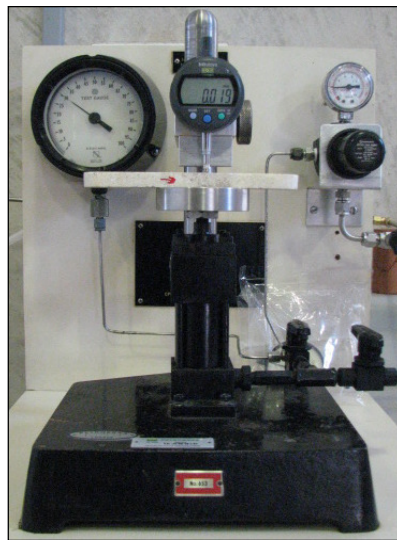
Figura 19 - Penetrômetro usado na medição de RES
