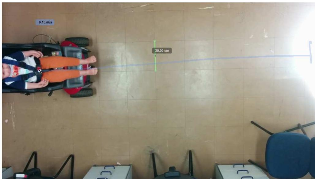
Figura 6.6: Trajetória percorrida com carga e velocidade reduzida inicial.
