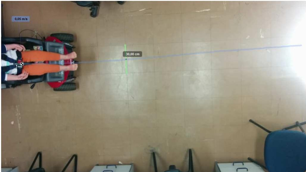
Figura 6.4: Trajetória percorrida com carga e velocidade máxima inicial.
