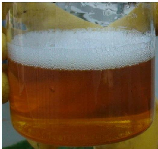
Figura 3.9: Óleo diesel coletado pelo dreno no recalque da bomba injetora de solução estoque de aditivo. A espuma é coletada juntamente com o diesel.
