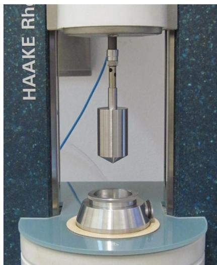
Figura 2.2: Fotografia do reômetro utilizado com a cela tipo Couette acoplada.
