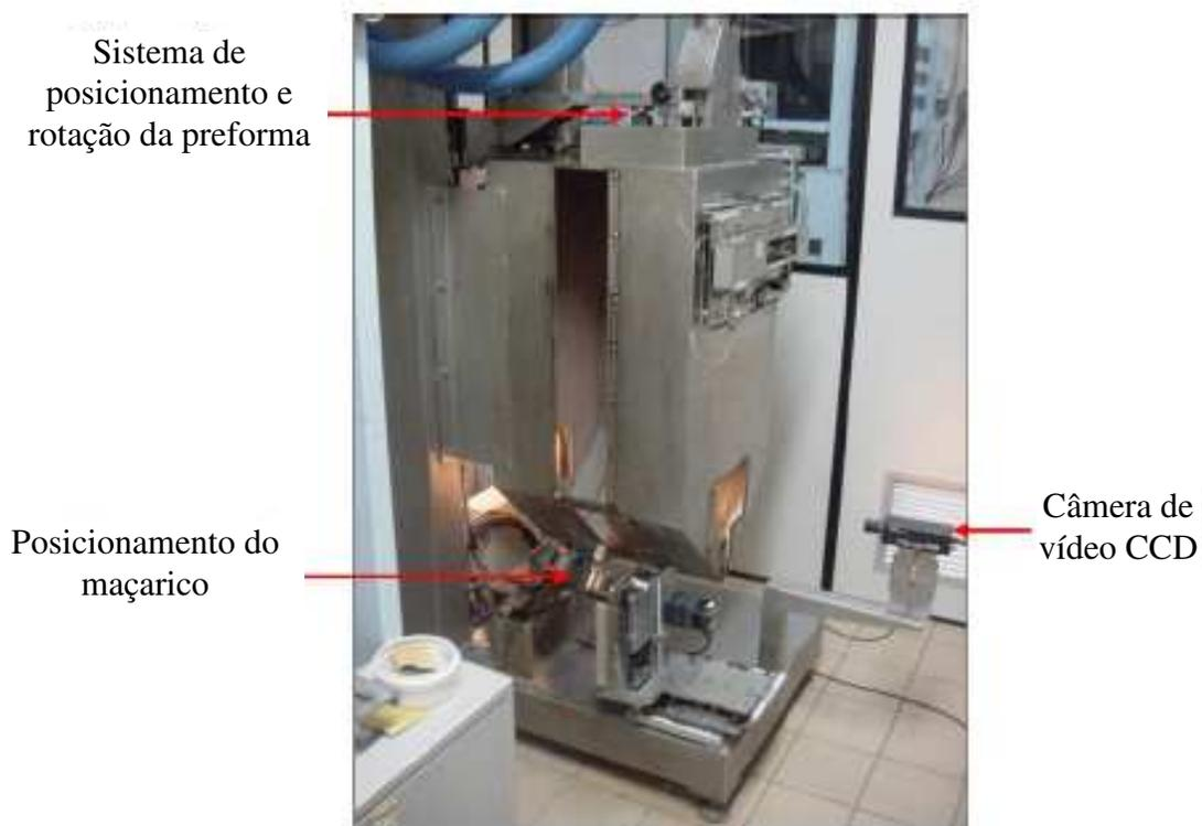
Figura 4.3: Câmara de deposição VAD piloto industrial.
