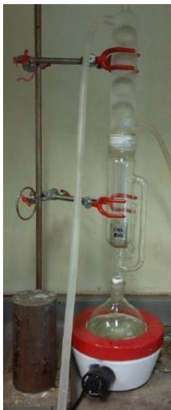
Figura 3.13. Equipamento de limpeza: Soxhlet. Fonte: Nunez (2017).
