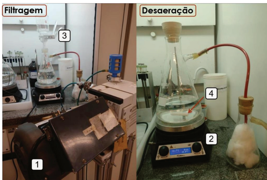
Figura 3.7. Processos de filtração e desaeração dos fluidos. 1) Bomba de vácuo 2) Agitador magnético 3) Filtro 22µm 4) barra magnética.
