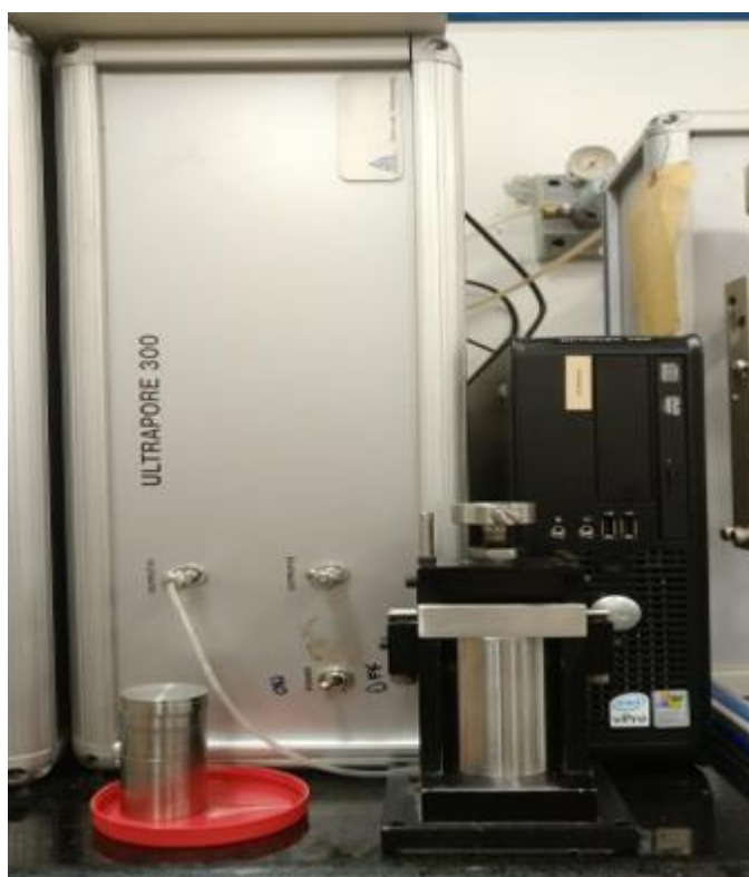
Figura 3.15. Ultrapore 300 utilizado para medição da porosidade.
