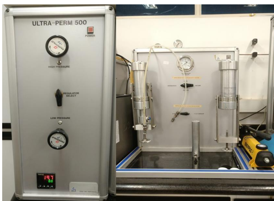
Figura 3.14. Ultraperm 500 utilizado para medição da permeabilidade.
