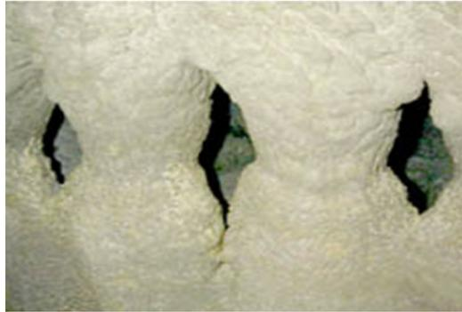
Figura 1.1 Deposição de sulfato de bário no separador de produção.
