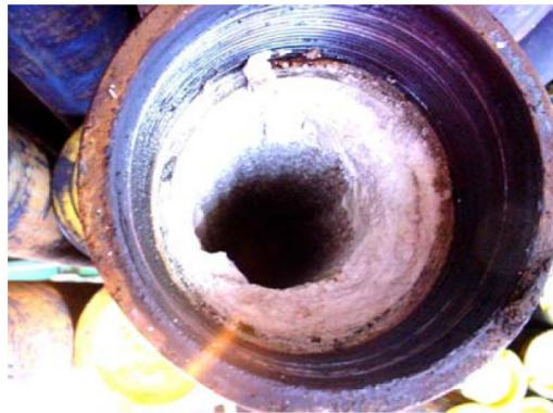
Figura 1.2 Deposição de sulfato de bário em coluna de produção no campo de Namorado (reproduzido de *Silva et al.*, 2007).
