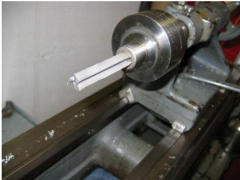
Figura. 2.5 Dispositivo para furos Poligonais no Torno Mecânico
