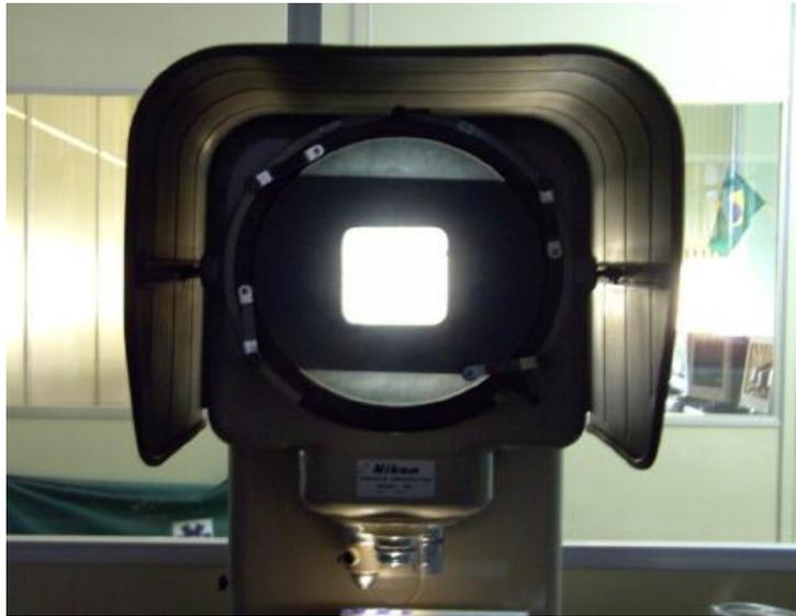
Figura. 2.8 – Imagem do Furo quadrado no Projetor de Perfil. (CASTRO, 2012)
