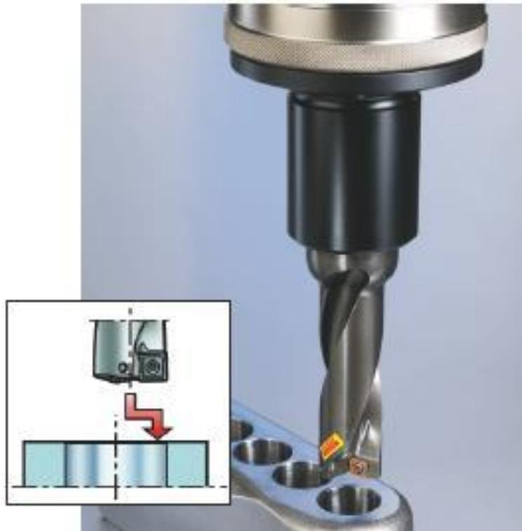
Figura. 2.14 – Broca de ajuste radial com pastilhas intercambiáveis. (SANDVIK, 2013)
