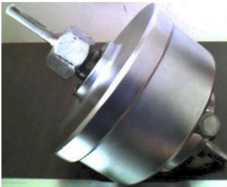
Figura. 2.6 - Dispositivo para obtenção de furo quadrado sem utilização de máscara guia. (BARROS, 2002)
