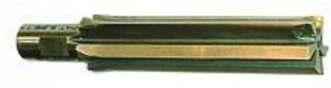
Figura. 2.3 Broca de 5 cortes para obtenção de furo sextavado
