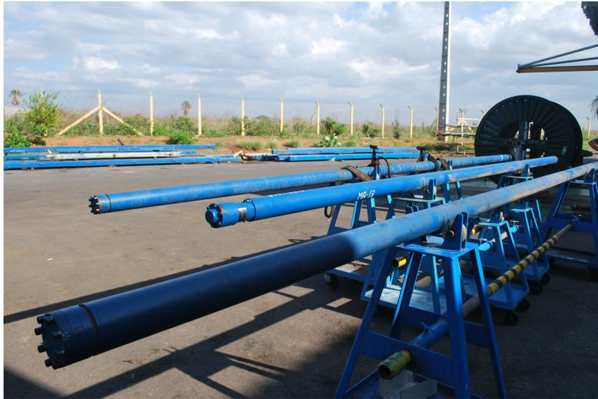
Figura 1.2 – Bombas e Motor Elétrico de BCS.
