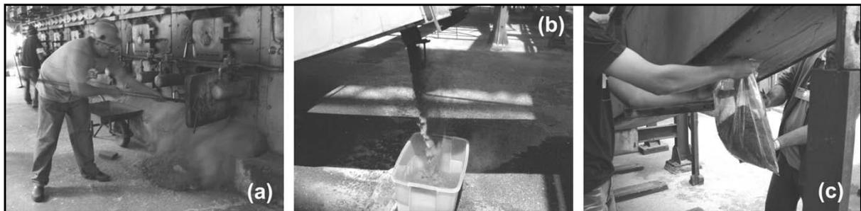
Figura 1.3 Coleta de cinzas em uma caldeira (a); Secas ao ar livre (b) e Coletadas em correia transportadora (c). (SALES, et al 2010).
