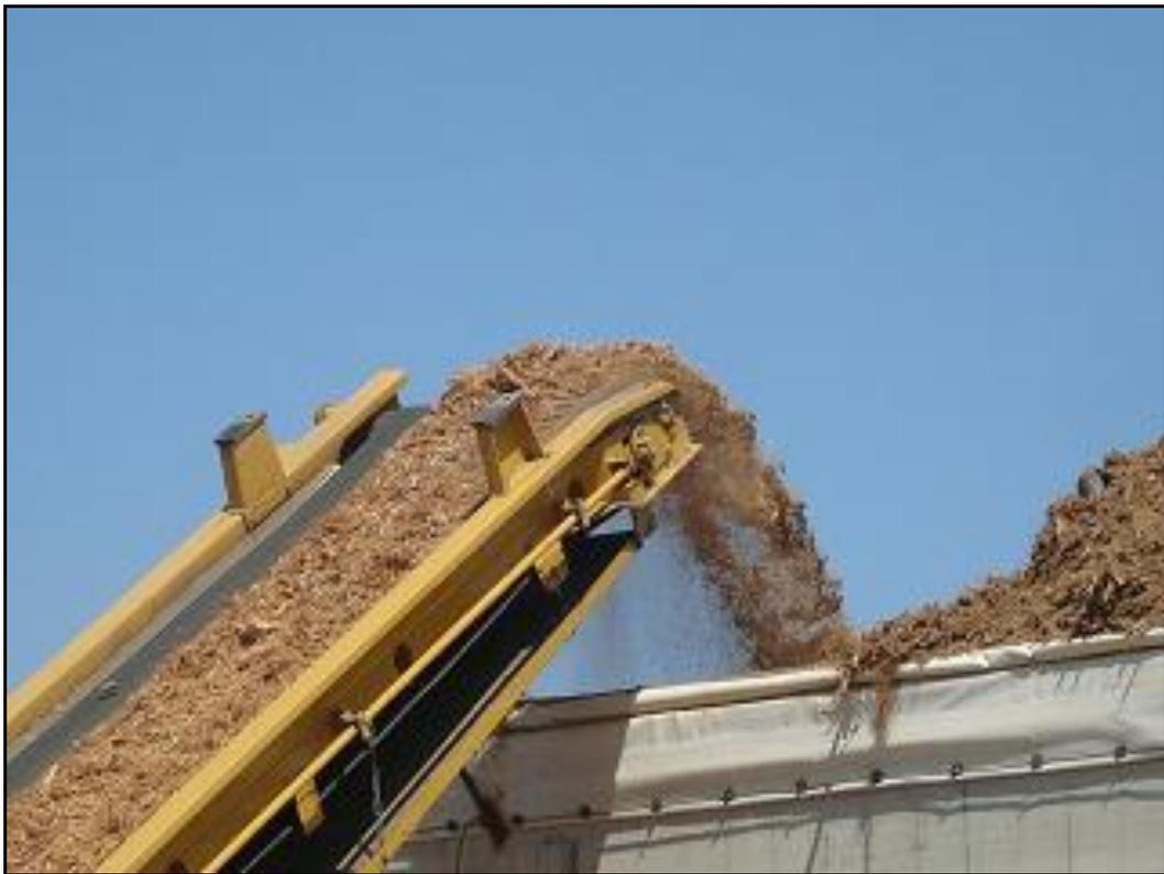
Figura 1.1: Transporte de bagaço de cana-de-açúcar por esteiras. (CBE, 2012)
