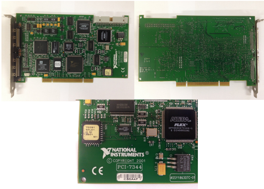
Figura 5.4: Controlador Placa Motion PCI 7344 utilizada no experimento
