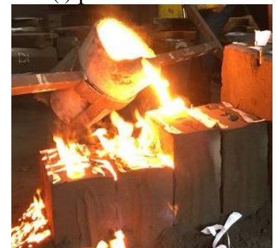
(o) vazamento do metal
