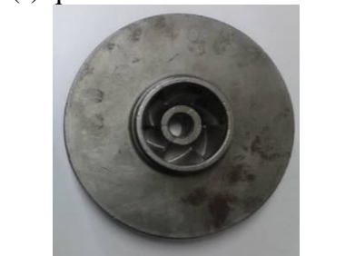
(u) peça rebarbada
