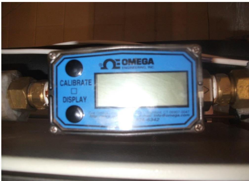
Figura 3.14 Medidor de vazão volumétrica tipo turbina.
