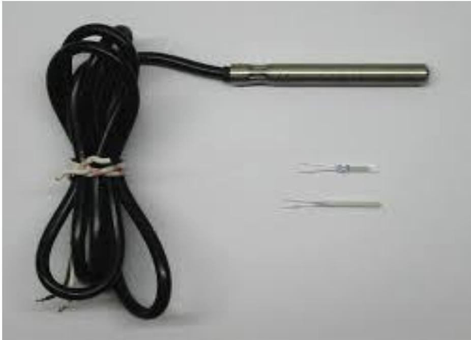
Figura 3.11 Termômetro de resistência.
