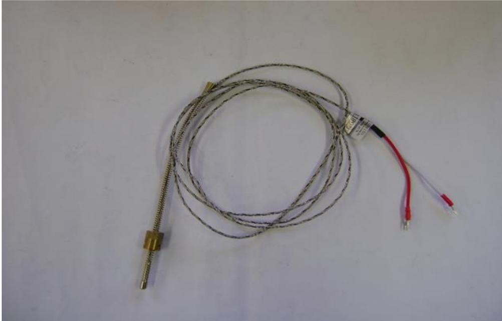
Figura 3.10 Termopar tipo T.
