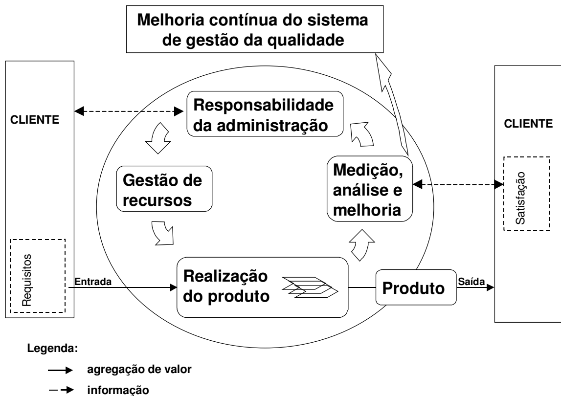
Figura 2.3 — Modelo de um sistema de gestão da qualidade baseado em processo (Fonte: NBR ISO 9001/2000 — Sistemas de gestão da qualidade — Requisitos — Associação Brasileira de Normas Técnicas, 2000a)
