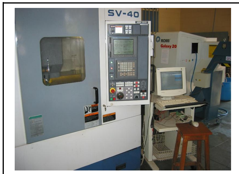
Figura 3.2 – Centro de usinagem vertical 3 eixos marca Mori Seiki
