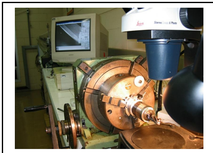
Figura 3.6 – Sistema de medição de desgaste utilizado nos ensaios
