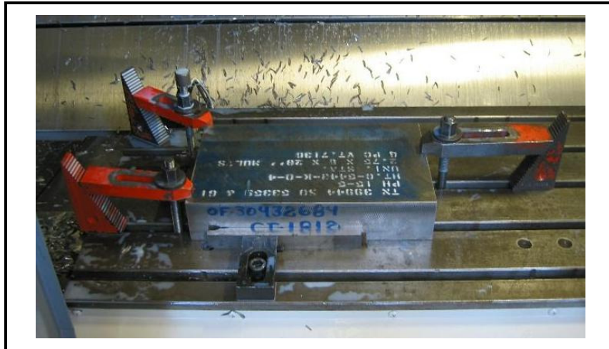
Figura 3.1 – Corpo de Prova fixado por três grampos sobre a mesa da máquina
