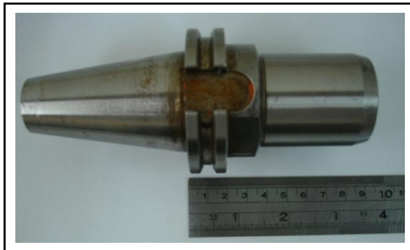
Figura 3.4 – mandril de fixação hidráulica da ferramenta
