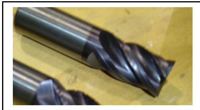
Figura 3.3 – fresa inteiraça de metal duro, 4 lâminas, utilizada nos ensaios
