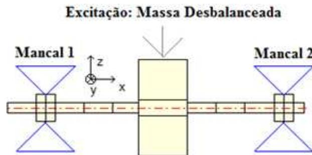
**Figura 6.7: Modelo em elementos finitos do rotor utilizado na bancada.**
