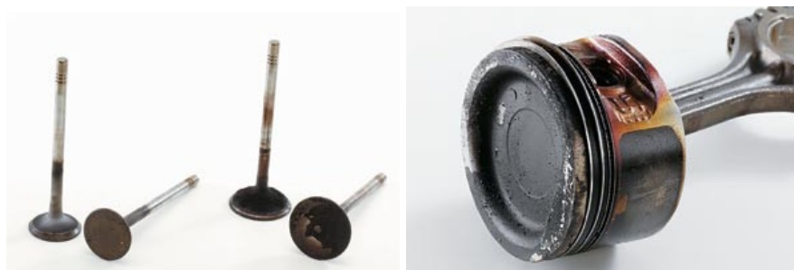
F 3.1 - Válvulas Limpas e Válvulas Carbonizadas; Conjunto Carbonizado de Pistão e Anéis.
