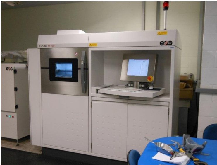
Figure 2: Foto do equipamento EOS de sinterização direta de metal por laser (Biofabris).
