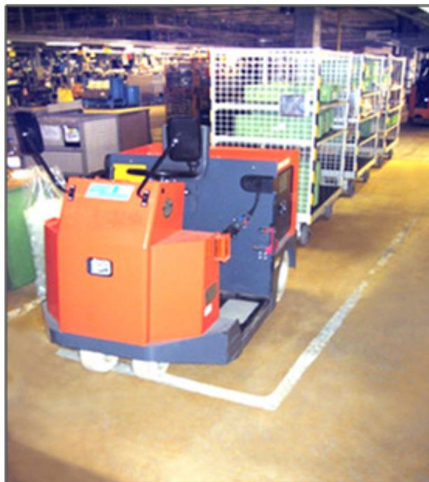
Figura 13 Carro motorizado para *milk run* interno
