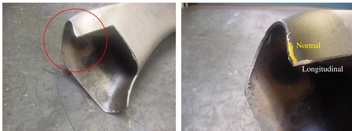
Figura 3.4: Foto da extremidade do tubo correspondente ao metal-base 1 mostrando as direções normal e longitudinal à superfície do tubo.
