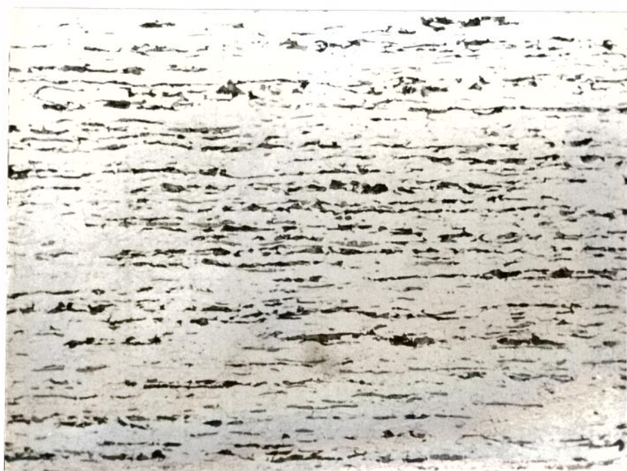
Figura 32. Microinclusões da amostra de aço SAE 12L14 com 41% redução de área (Rd 18,3 mm). Aumento de 200 vezes.
