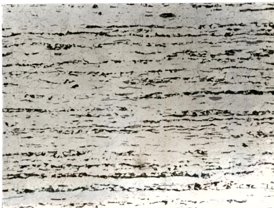
Figura 30. Microinclusões da amostra de aço SAE 12L14 com 22, de redução de área (Rd 21,2 mm). Aumento de 200 vezes.
