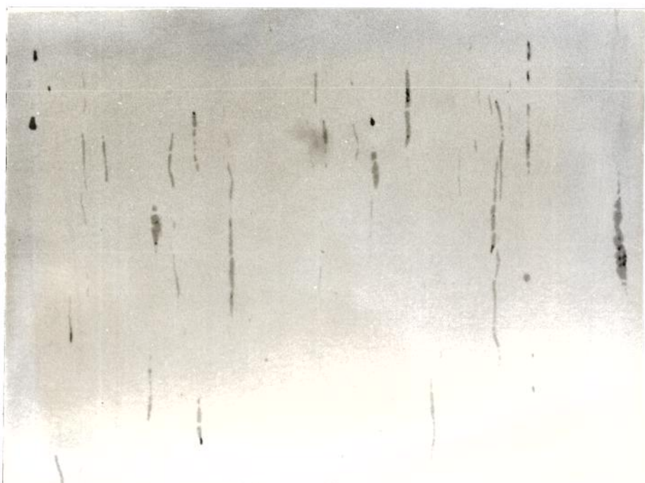
Figura 25. Microestrutura da amostra de aço SAE 12L14 com 37 % redução de área (Rd 19,0 mm). Aumento de 100 vezes. Ataque de nital.
