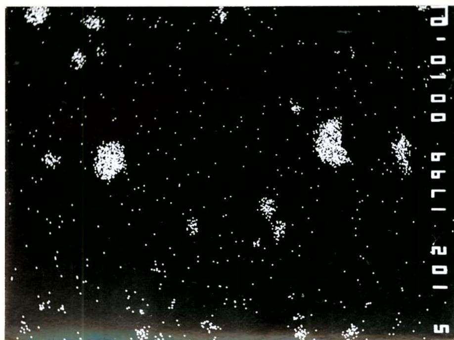
Figura 16. Aspecto da imagem de raio-x para o elemento enxofre em amostra de aço SAE 12L14. Aumento 1000 vezes.
