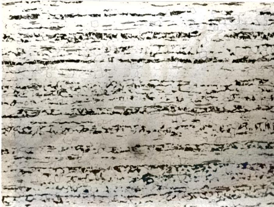
Figura 28. Microinclusões da amostra da aço SAE 12L14 na condição bruta de laminação (24,0 mm). Aumento de 200 vezes.
