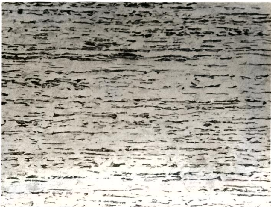
Figura 33. Microinclusões da amostra de aço SAE 12L14 com 51% redução de área (Rd 16,7 mm). Aumento de 200 vezes.
