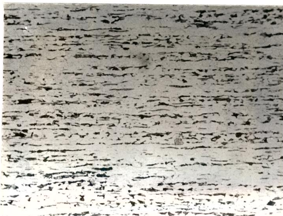
Figura 31. Microinclusões da amostra de aço SAE 12L14 com 37% redução de área (Rd 19,0 mm). Aumento de 200 vezes.
