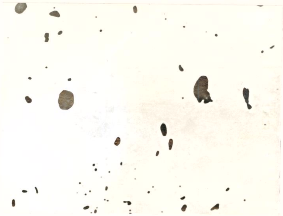
Figura 13. Aspecto das microinclusões em análise de raio-x da secção transversal de amostra de aço SAE 12L14. Aumento de 1000 vezes.
