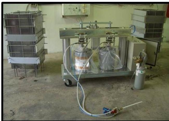
Figura 4.2 – Máquina utilizada para aplicação da resina.
