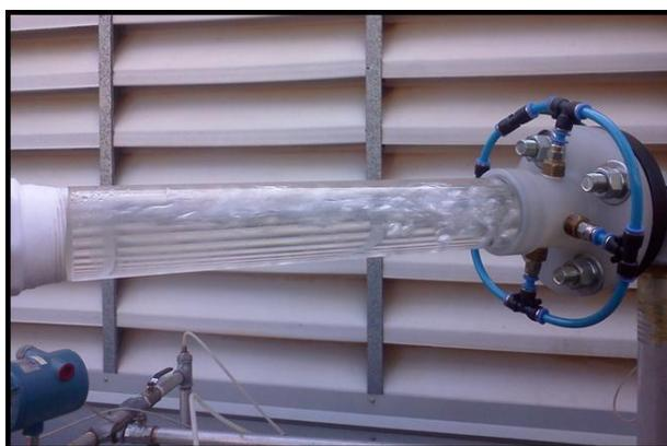
Figura 4.34 – Foto do difusor de ar completo e em funcionamento.
