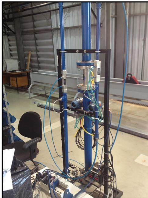
Figura E. 6 – Carrinho onde foram instalados o conjunto de instrumentos necessários para medir a vazão volumétrica de ar.
