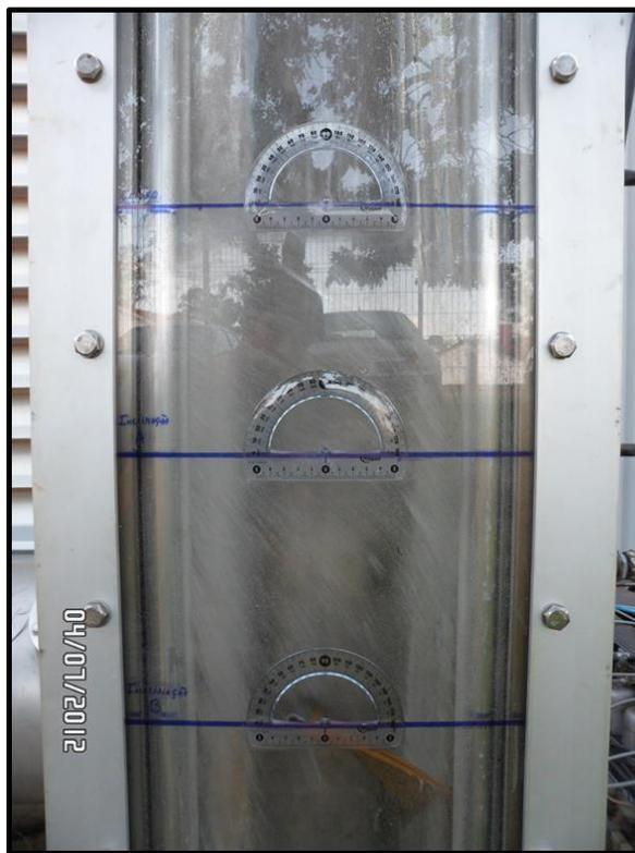
Figura 5.10 – Foto dos transferidores instalados na parede do separador durante seu funcionamento.
