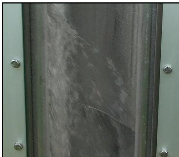
Figura 4.11 – Foto mostrando o filme de líquido na parede de acrílico passando direto pelo helicóide.
