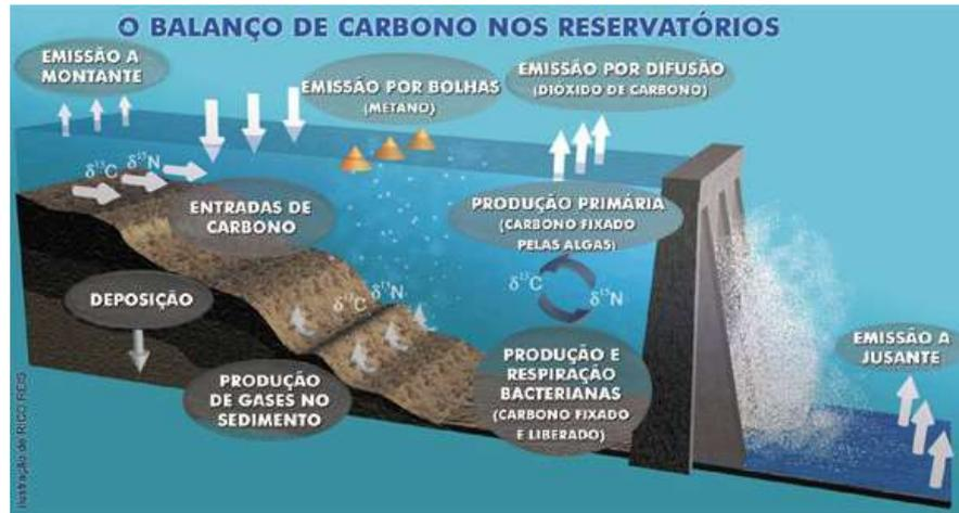
Figura 2. 4: Balanço de carbono nos reservatórios
