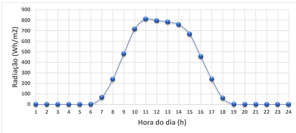
Figura 15. Curva de Radiação Solar média durante o dia (24h)
