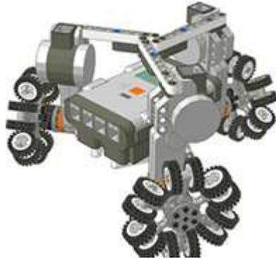
Figura 1.2: Robô móvel holonômico.
