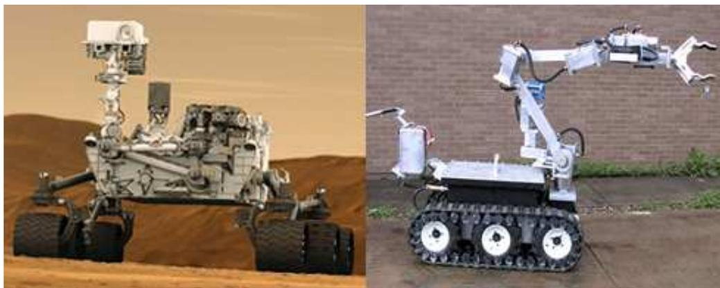
Figura 1.1: Exemplos de robôs móveis terrestres com rodas.
