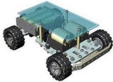
Figura 1.3: Robô móvel não holonômico.
