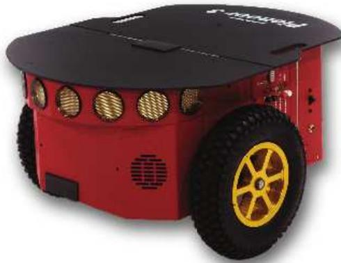
Figura 1.4: Robô móvel de tração diferencial.
