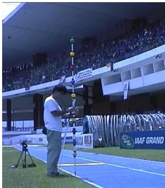
FIGURA 6. Bastão utilizado para obtenção da calibração das câmeras
