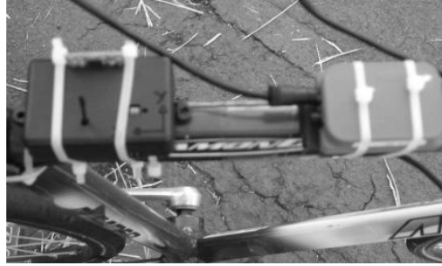
Figura 4: Posicionamento dos acelerômetros na bicicleta (1° - SM-MAE, 2° - comercial).
