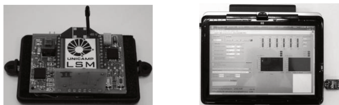
Figura 3: a) Placa móvel do SM-MAE, o qual é encapsulado para o uso; b) Interface gráfica com a placa base (extraída de ROA, 2009).
