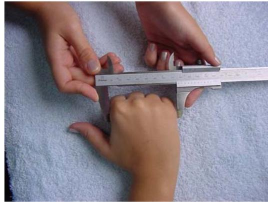
**Figura 9 - Medida da largura da palma (LM) realizada com o paquímetro.**
