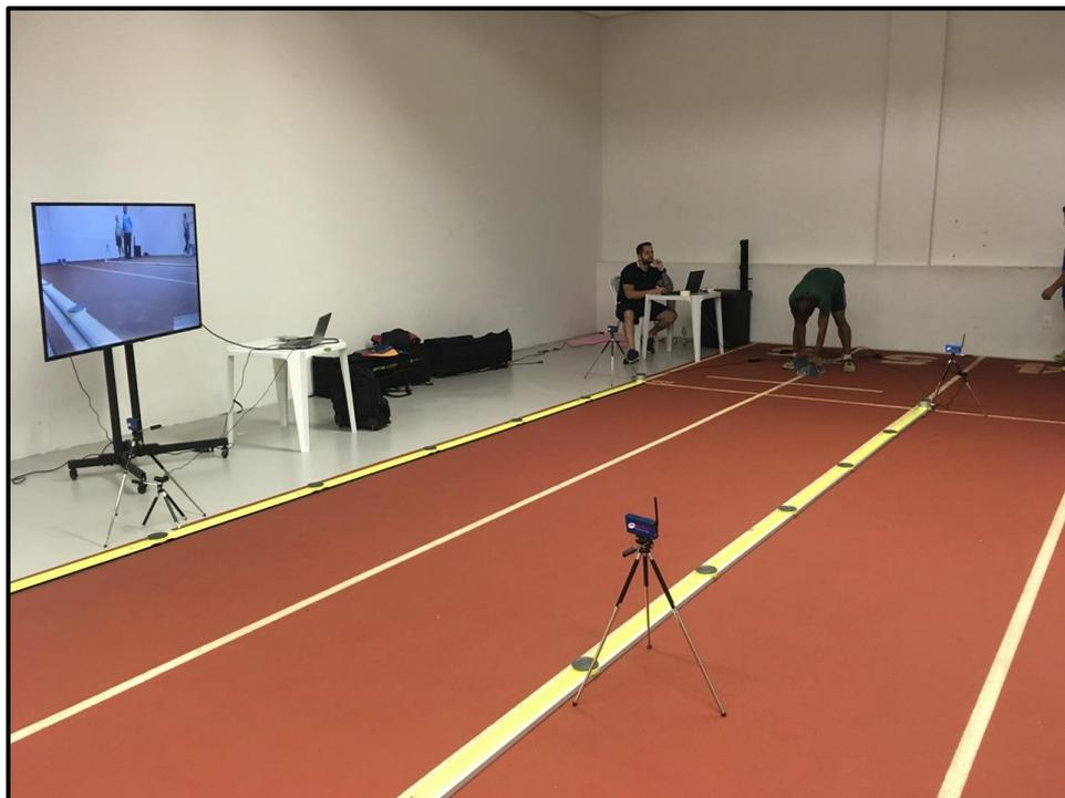
**Figura 1.** Disposição do conjunto de células fotoelétricas *Opto Jump Next* .
