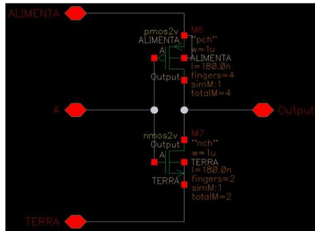
Figura C.2 - Esquemático da porta *VddINVGate*
