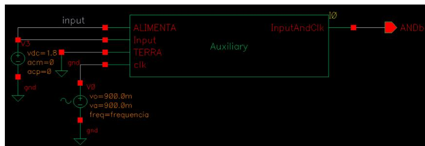
Figura 4.12 - Esquemático para simulação do bloco *Auxiliary*
