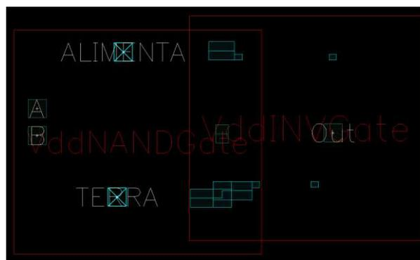
Figura C.12 - *Layout* da porta *VddANDGate* mostrando seus blocos e interconexões
