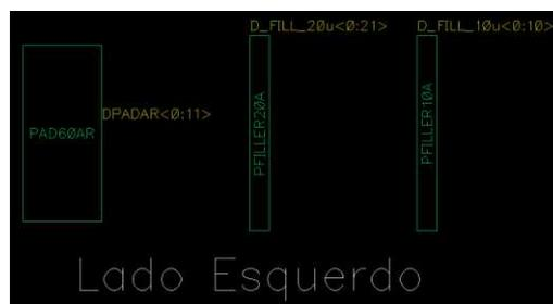
Figura 4.36 - Quantidade de células do tipo *Bond PAD* e *Filler* utilizadas no lado esquerdo do *I/O Ring*
