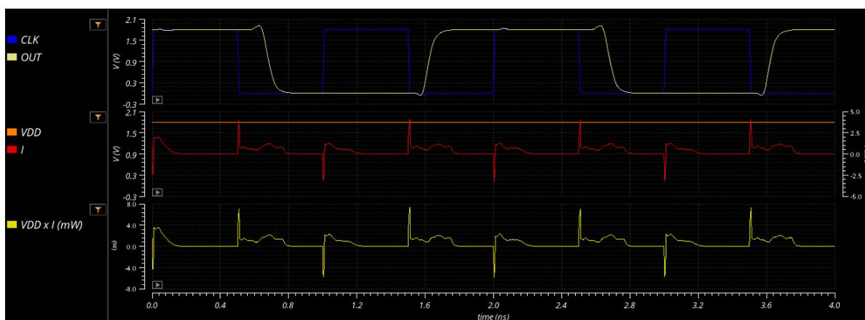
Figura 6.25 – Diagrama de sinais de tensão, corrente e potência do FF JK convencional
