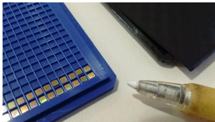
Figura 5.28 - Conjunto de *dies* fabricados
