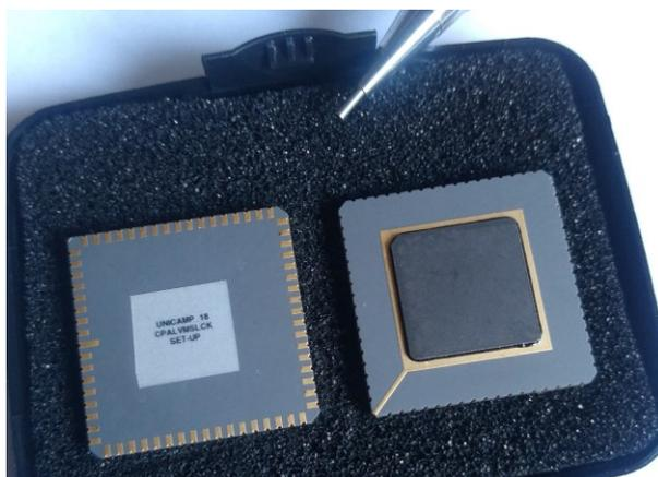
Figura 5.29 - Imagem das duas faces do circuito integrado fabricado
