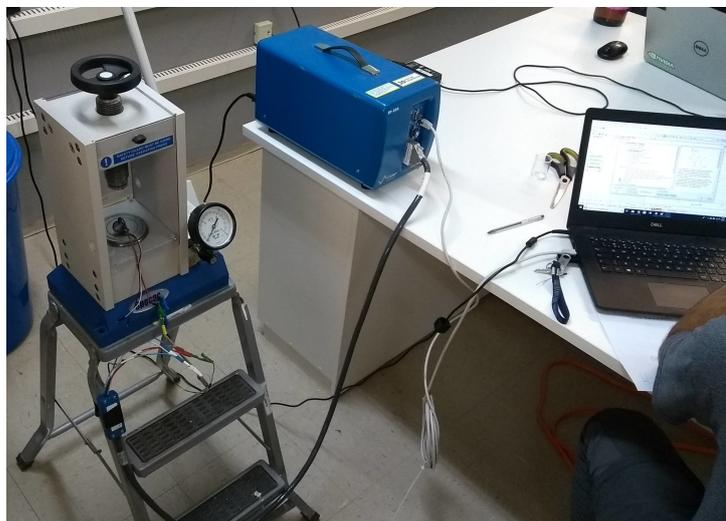
Figura 5.4 – Momento de tomada de medida de cronopotenciometria, no laboratório Carbon Sci-Tech Labs da Unicamp.
