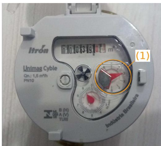
Figura 4.5 – Hidrômetro a ser utilizado. Destacado em (1) o local onde será instalado o sensor ótico.
