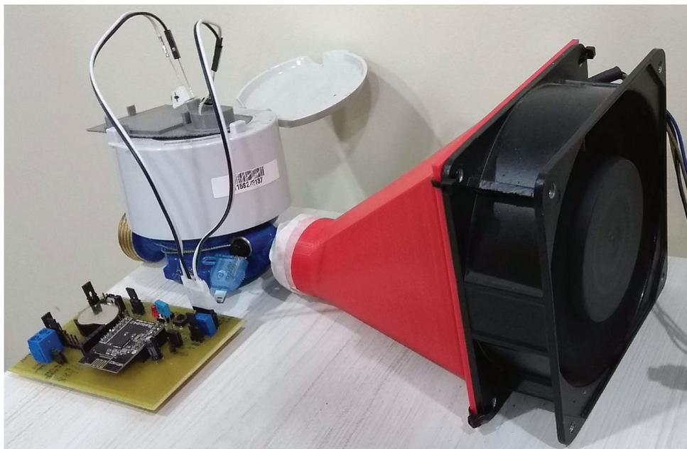
Figura 5.12 – Túnel de vento para simulação de fluxo de água.
