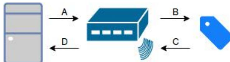
Figura 21: Função de Leitura de Etiqueta. Os passos A e D ocorrem com a interligação entre microcomputador e leitor via USB ou Ethernet. Os passos B e C ocorrem via sinal de RF (antena) entre leitor e etiqueta (Fonte: Autor).
