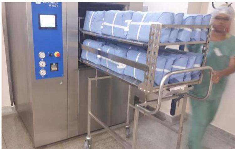
Figura 5: Esterilização - Área de Autoclaves, autoclave de barreira (Fonte: Autor).
