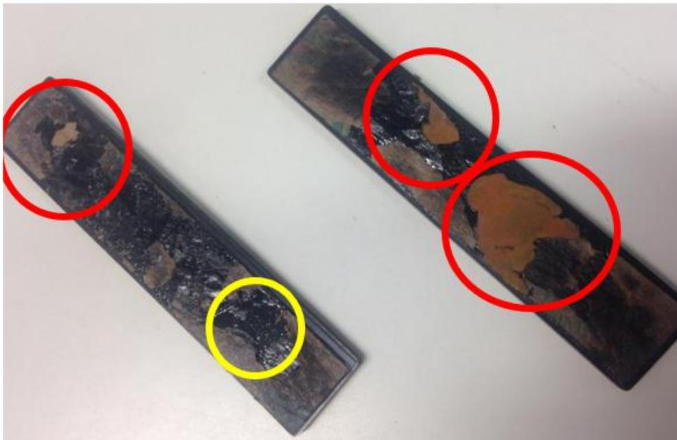
Figura 42: Fotos das etiquetas eletrônicas do fabricante A após o último ciclo de esterilização, com destaque para: em vermelho, rachaduras e material interno à mostra; em amarelo, a formação de bolhas (Fonte: Autor).
