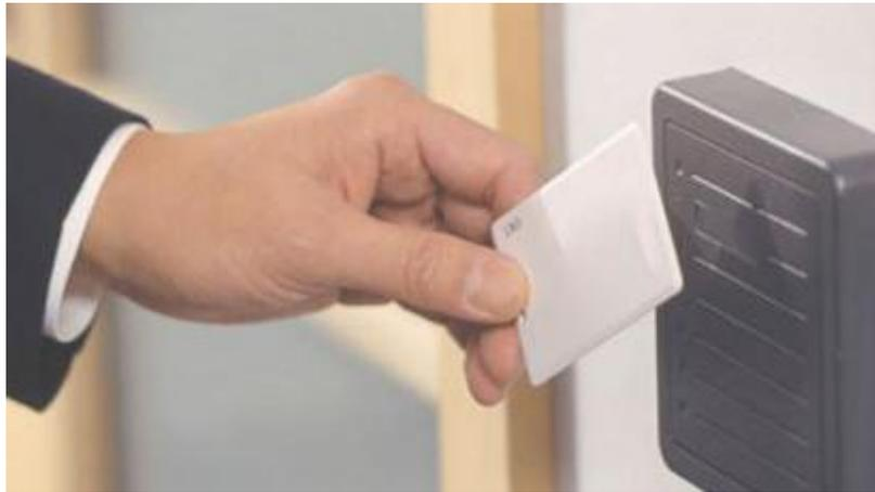
Figura 18: Cartão e leitor RFID, sistema indutivamente acoplado de curtíssimo alcance (Fonte: <https://www.rfid.ind.br/cartao-rfid>).
