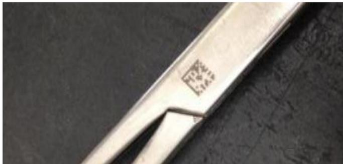
Figura 15: Instrumento cirúrgico marcado à laser com código *DataMatrix* (Fonte: Autor).
