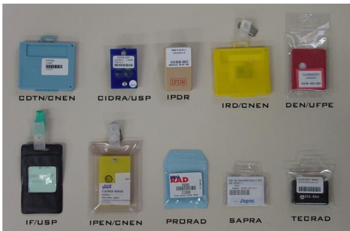
Figura 2.8. Dosímetros passivos utilizados por SMIEs autorizados pela CNEN a prestarem serviço de monitoração individual externa com dosimetria fotográfica (CDTN/CNEN, IRD/CNEN e DEN/UFPE) e com dosimetria termoluminescente (demais SMIEs) (ALENCAR, 2013).
