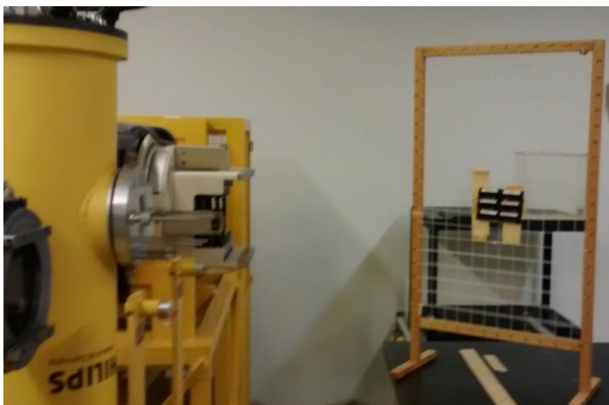
Figura 5.20. Arranjo experimental utilizado para avaliar o desempenho dos monitores desenvolvidos com respeito a diferentes direções da radiação incidente.
