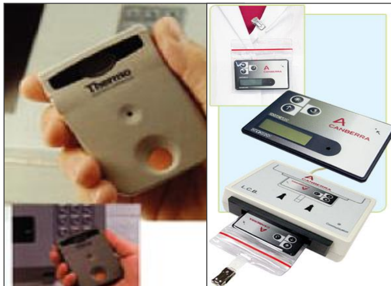
Figura 2.7. Exemplos de dosímetros pessoais ativos. À esquerda, é mostrado um dosímetro pessoal eletrônico (ativo) EPD Mk2 ( Thermo Scientific ) que opera com sistema dual para avaliar H_p(10) e H_p(0,07) (THERMO SCIENTIFIC, 2015); e à direita, é apresentado um dosímetro pessoal eletrônico Dosicard ( Canberra ) utilizado para avaliar H_p(10) (CANBERRA, 2015).
