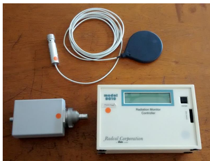
Figura 5.6. Câmara de ionização Radcal com volume sensível de 60 cm 3 utilizada em conjunto com eletrômetro e conversor da marca Radcal .
