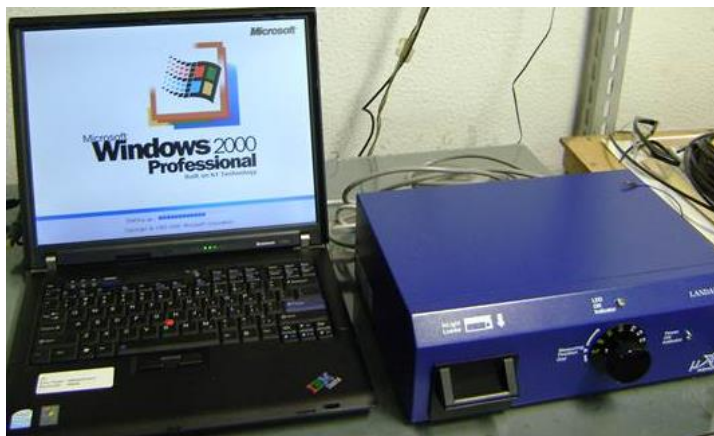
Figura 5.7. Leitor OSL MicroStar utilizado nas leituras de dosímetros baseados nos detectores de \text{Al}_2\text{O}_3:\text{C} , disponível no Laboratório do Grupo de Dosimetria das Radiações e Física Médica.
