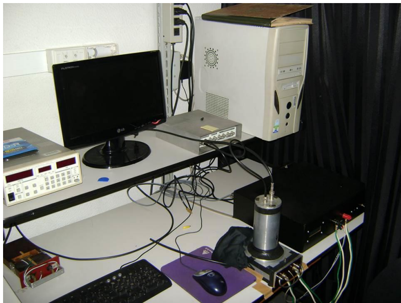
Figura 5.11. Sistema de dosimetria TL desenvolvido pelo Grupo de Dosimetria das Radiações e Física Médica do IFUSP.
