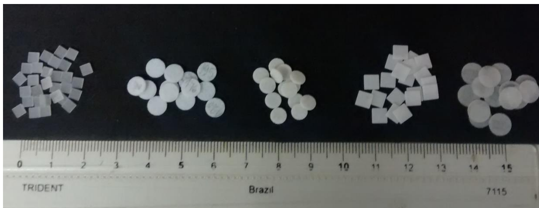
Figura 5.1. Da esquerda para a direita, detectores de \text{LiF:Mg,Ti} , \text{CaSO}_4\text{:Dy} , \text{CaF}_2\text{:natural} , \text{BeO} e \text{Al}_2\text{O}_3\text{:C} utilizados ao longo do projeto.
