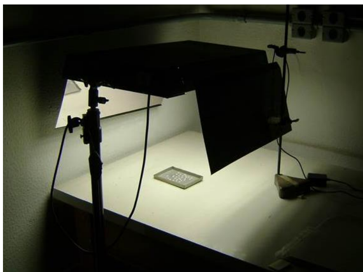
Figura 5.3. Foto do aparato para tratamento óptico ( bleaching ) com luz branca dos detectores de BeO e \text{Al}_2\text{O}_3\text{:C} utilizados com a técnica OSL.
