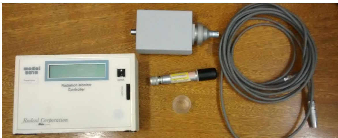
Figura 5.5. Câmara de ionização Radcal com volume sensível de 6 cm 3 e sua capa de equilíbrio eletrônico utilizada em conjunto com eletrômetro e conversor da marca Radcal .
