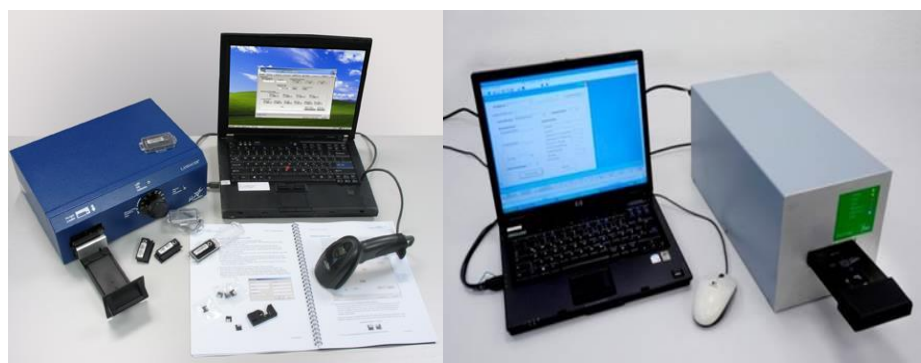
Figura 3.9. Leitores OSL manuais disponíveis comercialmente. À esquerda é apresentado o Leitor OSL Microstar (Landauer Inc.) cujo sistema foi desenvolvido para ler o sinal OSL inicial de dosímetros compostos por detectores de \text{Al}_2\text{O}_3:\text{C} . À direita é apresentado o leitor OSL BeOSL Reader (Dosimetrics) desenvolvido para ler especificamente sinal OSL de dosímetros compostos pelo material detector \text{BeO} .
