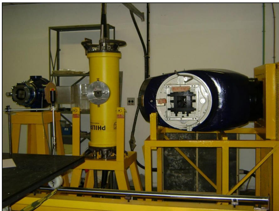
Figura 5.4. Fontes de radiação: fonte de ^{137}\text{Cs} (à direita) tubo de raios - X (centro) fonte de ^{60}\text{Co} (à esquerda).
