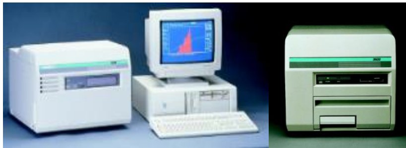
Figura 3.7. Leitores comerciais TL da marca Harshaw automatizado (à direita) e manual (à esquerda) (THERMO SCIENTIFIC, 2015a).
