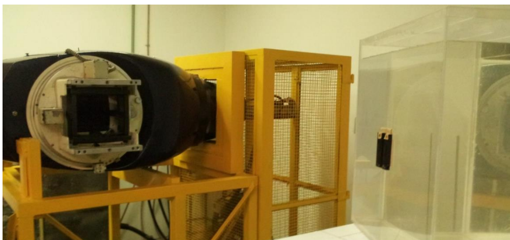
Figura 5.19. Arranjo experimental utilizado para avaliar o desempenho dos monitores desenvolvidos com respeito à direção ( 60^\circ ) e energia da radiação incidente.
